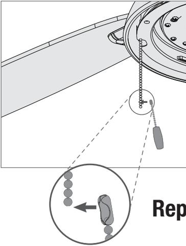
Pase las cadenas para tirar desde el interruptor del ventilador y el interruptor de luz hacia abajo por los orificios en la caja del interruptor superior. Conecte el pendiente de tirador de cadenas a las cadenas para tirar para luz y ventilador.
