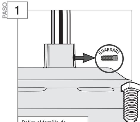
Retire el tornillo de fijación preinstalado para poder insertar la varilla.
