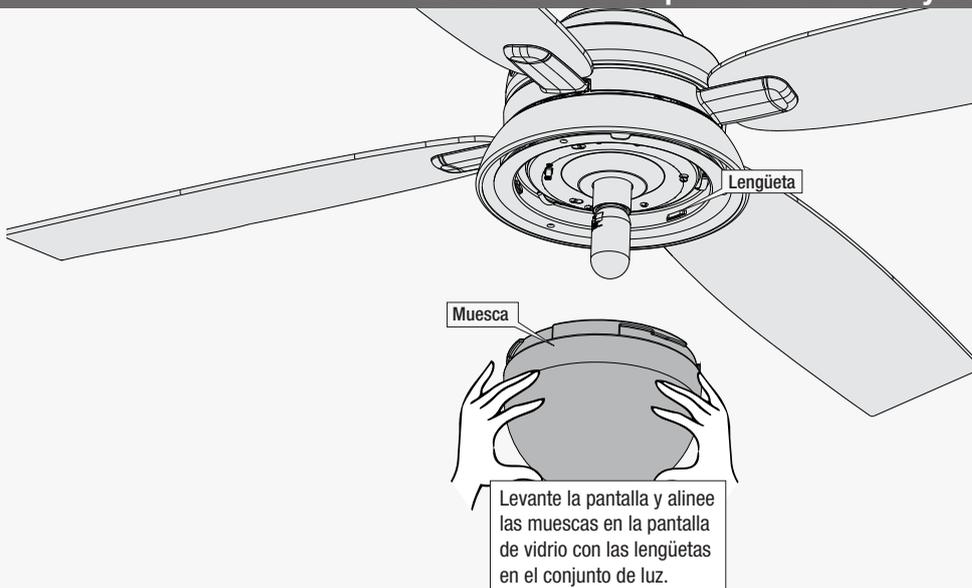
Levante la pantalla y alinee las muescas en la pantalla de vidrio con las lengüetas en el conjunto de luz.
