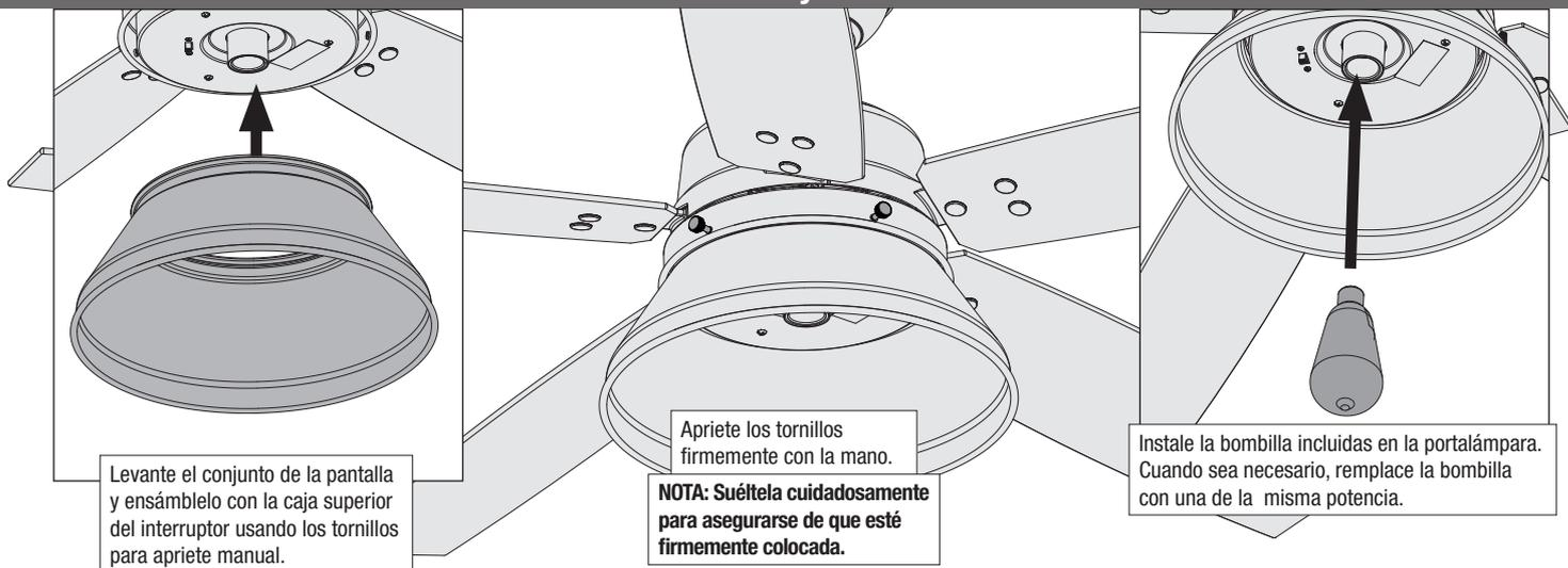
Levante el conjunto de la pantalla y ensámblelo con la caja superior del interruptor usando los tornillos para apriete manual.
