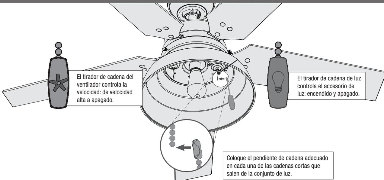
El tirador de cadena del ventilador controla la velocidad: de velocidad alta a apagado.
