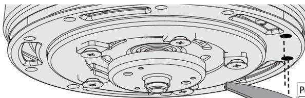
Acople sin emplear mucha fuerza los soportes de paleta al motor con los tornillos de la bolsa de materiales ☒, luego apriete con firmeza, cuando ambos tornillos estén acoplados.
