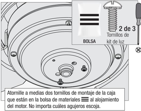
Atornille a medias dos tornillos de montaje de la caja que están en la bolsa de materiales
