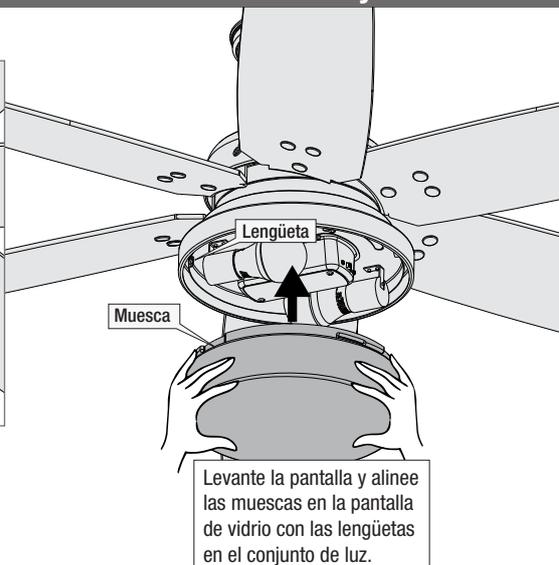
Levante la pantalla y alinee las muescas en la pantalla de vidrio con las lengüetas en el conjunto de luz.
