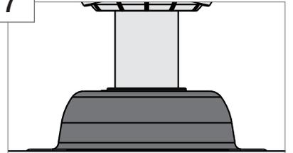
Baje la cubierta del adaptador hasta que descansa a nivel contra el alojamiento del motor.
