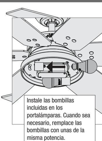
Instale las bombillas incluidas en los portalámparas. Cuando sea necesario, reemplace las bombillas con unas de la misma potencia.
