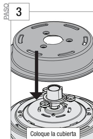
Coloque la cubierta superior del motor en su posición en la parte superior del ventilador.
