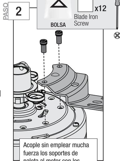
Acople sin emplear mucha fuerza los soportes de paleta al motor con los tornillos de la bolsa de materiales X, luego apriete con firmeza, cuando ambos tornillos estén acoplados.
