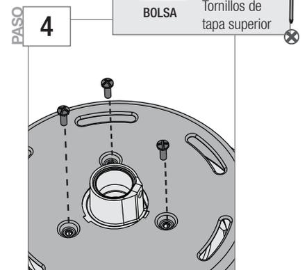
Alinee las muescas en la carcasa superior del motor con las pestañas en el adaptador del motor. Inserte los tornillos del motor superior, que se encuentra en la bolsa de materiales ●, y ajústelos bien.
