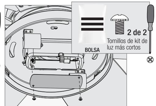
Empuje cuidadosamente todos los componentes de la caja del interruptor en la caja del interruptor, luego instale la placa de la caja del interruptor usando dos tornillos de ensamble del conjunto de lámparas que se encuentran en la
