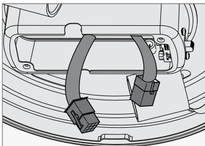
Pase el conector de 9 pines que viene de la parte inferior del alojamiento del motor a través de orificio central en el conjunto de lámparas. Conéctelo en el conector de enchufe que se encuentra en el área de la caja del interruptor del conjunto de lámparas. Asegúrese de alinear las marcas de color de los conectores.
