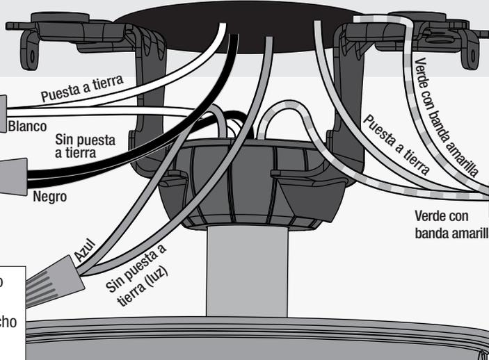
Conecte el cable negro (sin toma a tierra) del techo al cable negro del ventilador.
