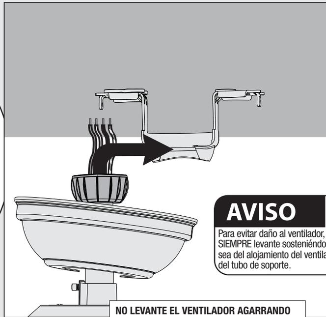
**NO LEVANTE EL VENTILADOR AGARRANDO LA CAMPANA O LOS CABLES.** Coloque la bola de la varilla en la ranura del soporte de techo.
