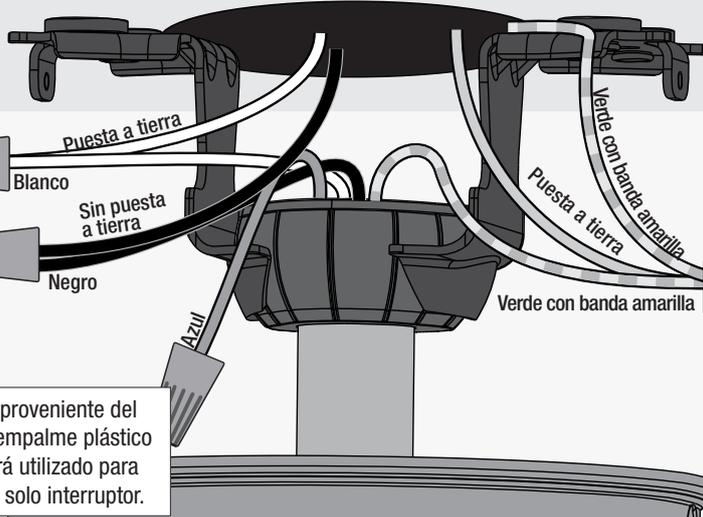
Conecte el cable negro (sin toma a tierra) del techo a los cables negro y azul del ventilador.
