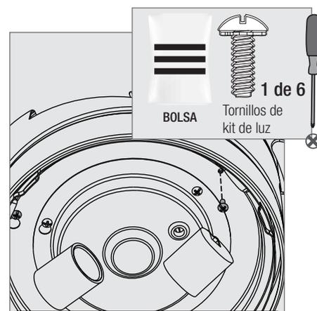
Gire el conjunto de luz en sentido antihorario hasta que los tornillos de ensamblaje de la caja estén firmemente colocados en el extremo angosto de las ranuras de bocallave. Instale el tornillo restante en la caja. Apriete los tres tornillos firmemente.
