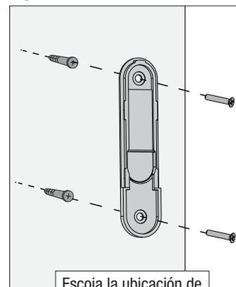
Si está instalando sobre un panel de yeso, perforo dos orificios de 9/64" de ancho usando el soporte de la base como una guía. Martille con cuidado las anclas para panel de yeso incluidas en los orificios previamente perforados.
