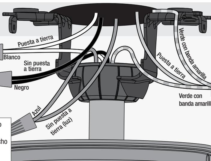
Conecte los tres cables de toma de tierra (verde, con raya verdes/amarilla, o de cobre desnudo) procedente del techo, de la varilla hueca y del soporte para montaje.
