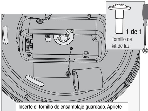
Inserte el tornillo de ensamblaje guardado. Apriete firmemente todos los tres tornillos.
