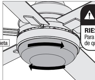
Para sujetar la pantalla de vidrio, levántela y hágala girar hacia la derecha un tercio de vuelta completa de la pantalla hasta que se detenga.
