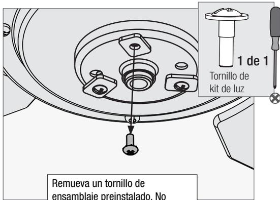
Remueva un tornillo de ensamblaje preinstalado. No importa cuál tornillo elijas.
