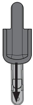
Deslice la base sobre el soporte ya montado.
