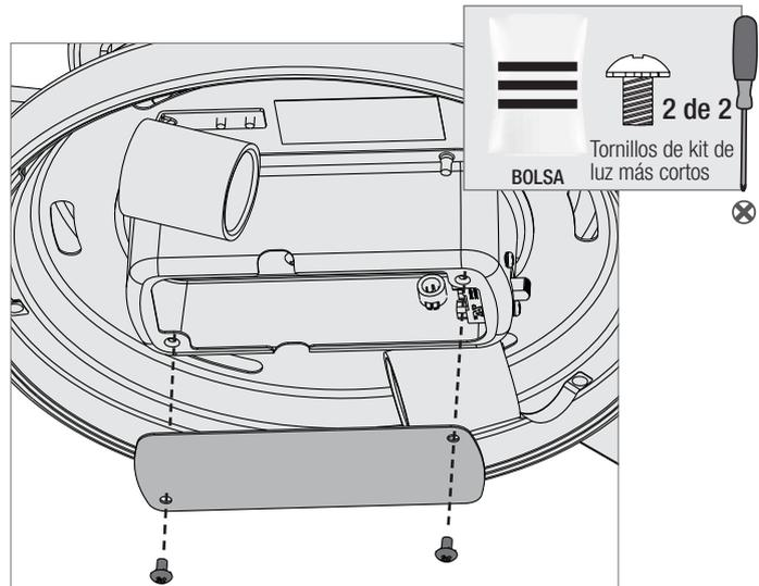
Empuje cuidadosamente todos los componentes de la caja del interruptor en la caja del interruptor, luego instale la placa de la caja del interruptor usando dos tornillos de ensamblaje del conjunto de lámparas que se encuentran en la bolsa de herrajes.
