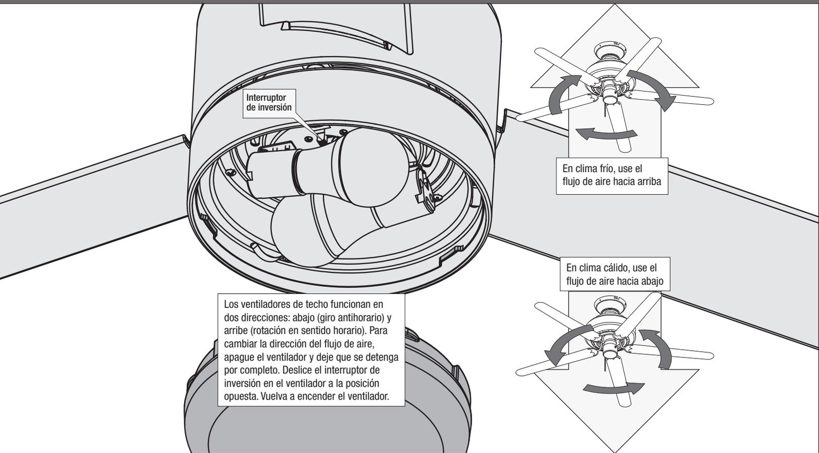
Los ventiladores de techo funcionan en dos direcciones: abajo (giro antihorario) y arriba (rotación en sentido horario). Para cambiar la dirección del flujo de aire, apague el ventilador y deje que se detenga por completo. Deslice el interruptor de inversión en el ventilador a la posición opuesta. Vuelva a encender el ventilador.
