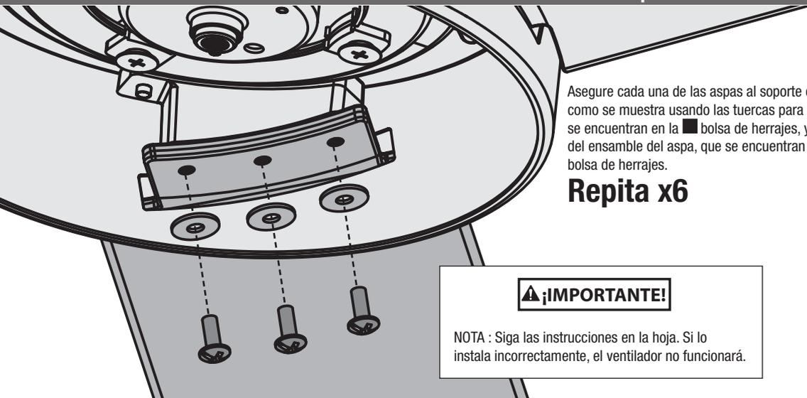
Asegure cada una de las aspas al soporte del aspa como se muestra usando las tuercas para el aspa que se encuentran en la ■ bolsa de herrajes, y los tornillos del ensamble del aspa, que se encuentran en la ▲ bolsa de herrajes.
