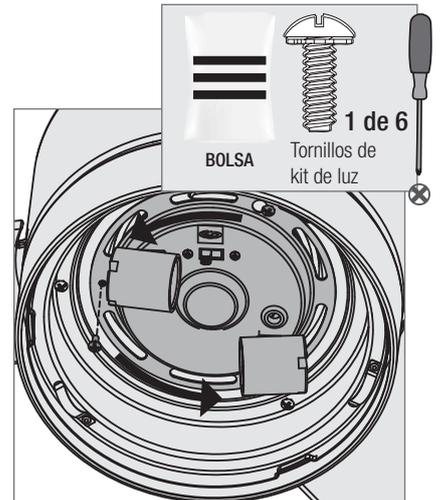
Gire el conjunto de luz en sentido antihorario hasta que los tornillos de ensamblaje de la caja estén firmemente colocados en el extremo angosto de las ranuras de bocallave. Instale el tornillo restante en la caja. Apriete los tres tornillos firmemente.
