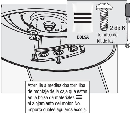
Atornille a medias dos tornillos de montaje de la caja que están en la bolsa de materiales
