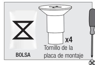
Hay cuatro orificios en el motor. Levante la placa de montaje y alinee los orificios de la placa de montaje con los orificios del motor. No importa cuál orificio usted elija. Instale los tornillos de la placa de montaje que se encuentran en la bolsa de tornillería para asegurar la placa de montaje al ventilador
