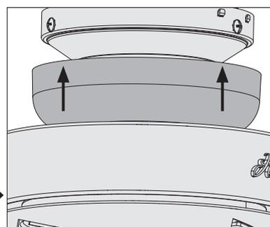
Con las dos manos empuje el anillo de la moldura de campana hasta la parte superior de la campana. Escuchará un clic y el anillo de la moldura de campana quedará asegurado en posición.
