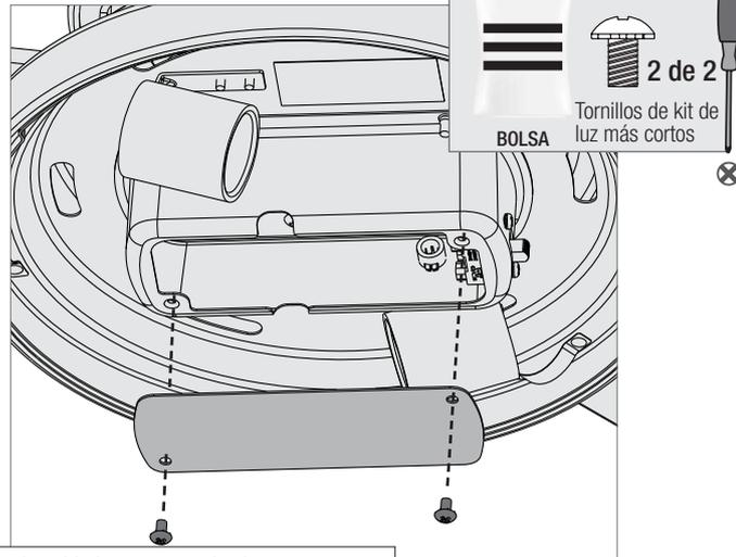
Empuje cuidadosamente todos los componentes de la caja del interruptor en la caja del interruptor, luego instale la placa de ensamble del conjunto de lámparas que se encuentran en la
