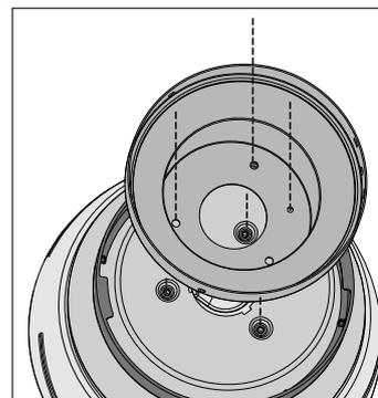
Coloque la campana en la tapa superior. Asegure todos los cuatro orificios para tornillos estén alineados hacia arriba con los orificios para tornillos en la tapa superior y en el adaptador.
