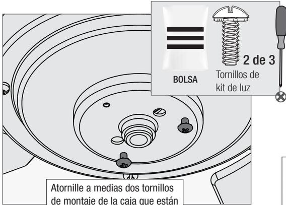
Atornille a medias dos tornillos de montaje de la caja que están en la bolsa de materiales
