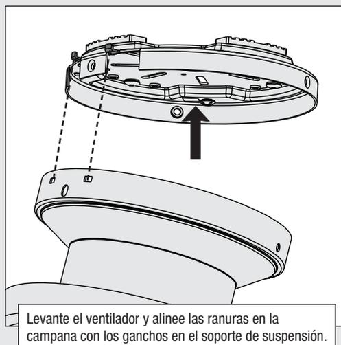
**Nota:** Para colgar el ventilador, debe inclinar la campana a una posición casi vertical para que las ranuras de la campana se asienten en los ganchos del soporte de suspensión.
