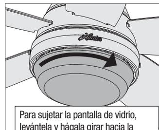
Para sujetar la pantalla de vidrio, levántela y hágala girar hacia la derecha un tercio de vuelta completa de la pantalla hasta que se detenga.
