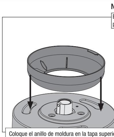
Coloque el anillo de moldura en la tapa superior.
