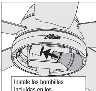
Instale las bombillas incluidas en los portalámparas. Cuando sea necesario, reemplace las bombillas con unas de la misma potencia.
