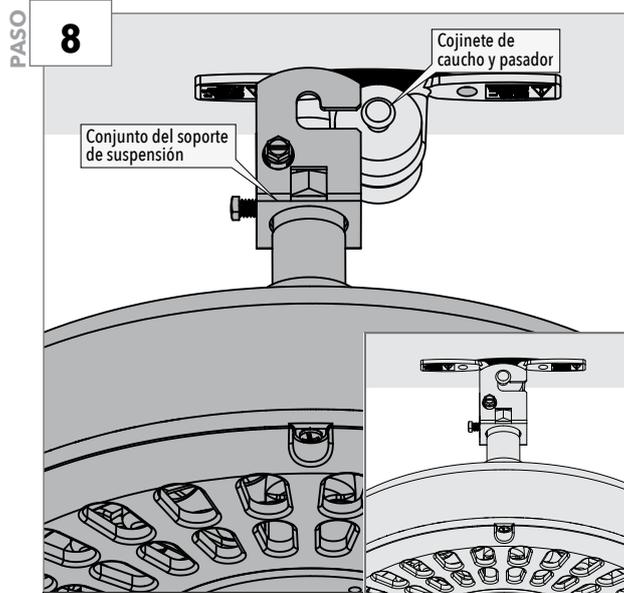
Eleve el ventilador por el alojamiento del motor. Enganche el conjunto del soporte de suspensión en el cojinete de caucho y el pasador. Asegúrese de que ambos extremos del pasador queden por fuera del conjunto del soporte de suspensión
