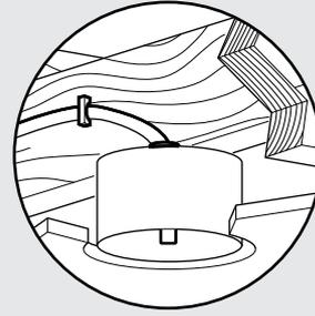
Debe poder asegurar el ventilador a la estructura de la edificación o una caja de salida aprobada para ventiladores.
