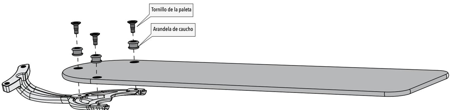
Inserte las arandelas que encontrará en la bolsa de herrajes ■ en los orificios de las paletas, luego asegure cada paleta a un soporte de paleta con los tornillos de la bolsa de herrajes ▲.
