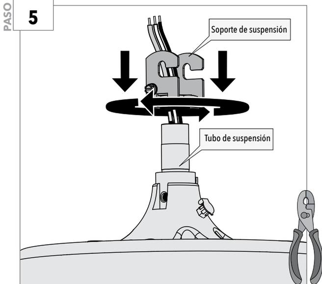
Retire el tornillo de fijación en el soporte de suspensión. Pase los cables por el conjunto del soporte de suspensión y enrosque el soporte de suspensión en el tubo de suspensión hasta que quede ajustado (por lo menos 3 vueltas). Luego use alicates para apretar el conjunto de soporte de suspensión y el tubo de suspensión.
