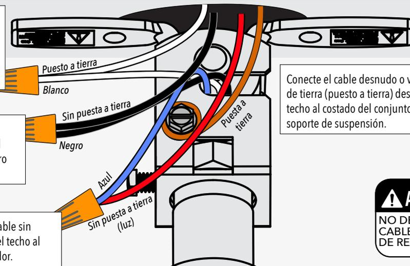
Conecte el cable negro (sin puesta a tierra) del techo con el cable negro del ventilador.
