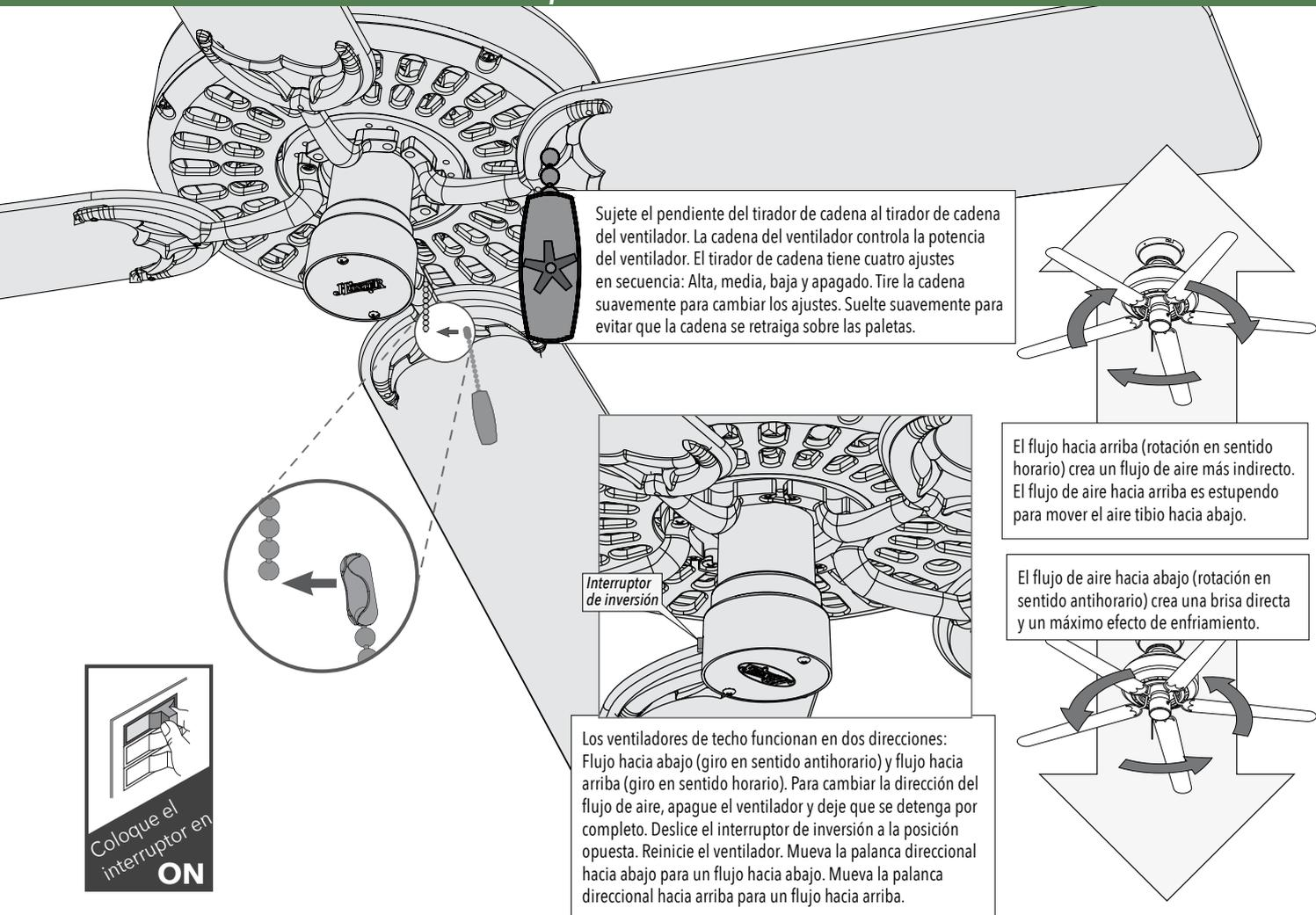
Sujete el pendiente del tirador de cadena al tirador de cadena del ventilador. La cadena del ventilador controla la potencia del ventilador. El tirador de cadena tiene cuatro ajustes en secuencia: Alta, media, baja y apagado. Tire la cadena suavemente para cambiar los ajustes. Suelte suavemente para evitar que la cadena se retraiga sobre las paletas.
