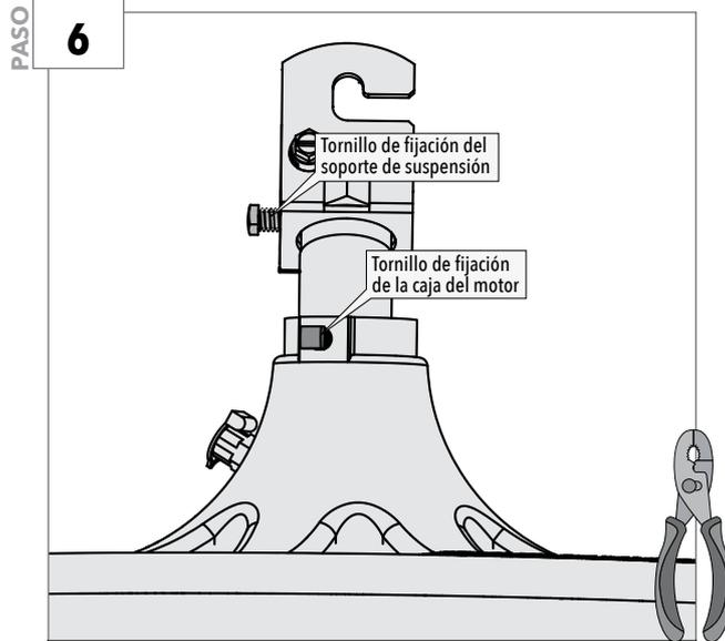
Ajuste el tornillo de fijación en el alojamiento del motor y el conjunto del soporte de fijación
