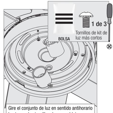
Gire el conjunto de luz en sentido antihorario hasta que los tornillos de ensamble de la caja estén firmemente colocados en el extremo angosto de las ranuras de bocallave. Instale el tornillo restante en la caja. Apriete los tres tornillos firmemente.
