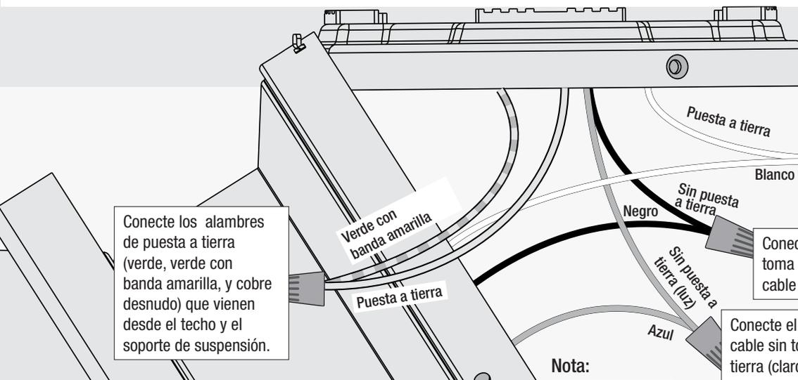
Conecte los alambres de puesta a tierra (verde, verde con banda amarilla, y cobre desnudo) que vienen desde el techo y el soporte de suspensión.
