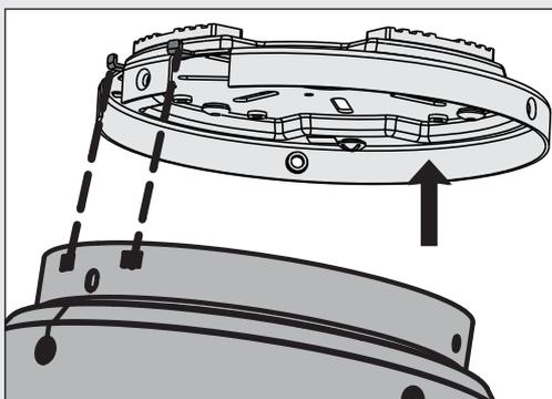
Levante el ventilador y alinee las ranuras en la campana con los ganchos en el soporte de suspensión.
