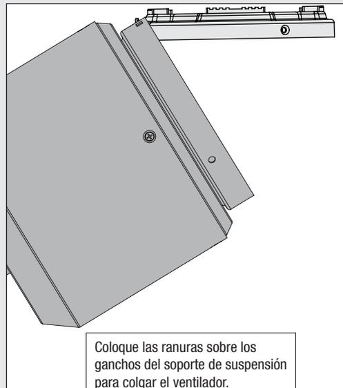
Coloque las ranuras sobre los ganchos del soporte de suspensión para colgar el ventilador.
