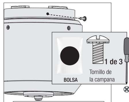
Instale parcialmente un tornillo de la campana, encontrado en la **BOLSA** de materiales, que está entre los ganchos del soporte de suspensión. Cuando los orificios estén bien alineados, apriete firmemente los tres tornillos de la campana.
