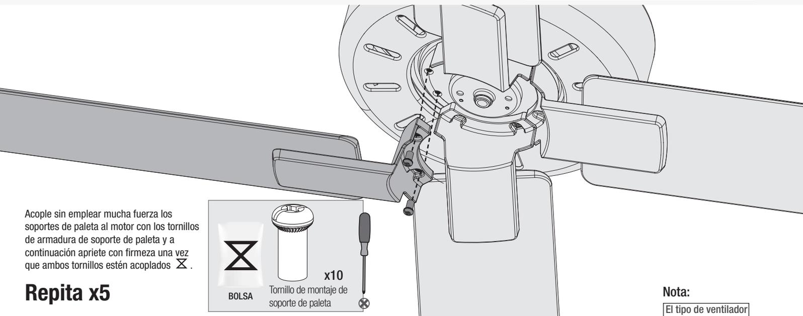
Acople sin emplear mucha fuerza los soportes de paleta al motor con los tornillos de armadura de soporte de paleta y a continuación apriete con firmeza una vez que ambos tornillos estén acoplados **X**.
