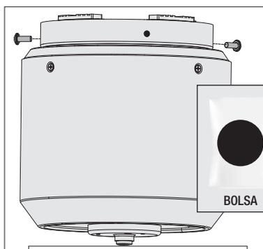
Sostenga arriba la campana con los orificios para tornillos bien alineados. Instale parcialmente dos tornillos de la campana, que se encuentran en la **BOLSA** de materiales, dentro de los orificios opuestos a los ganchos del soporte de suspensión.
