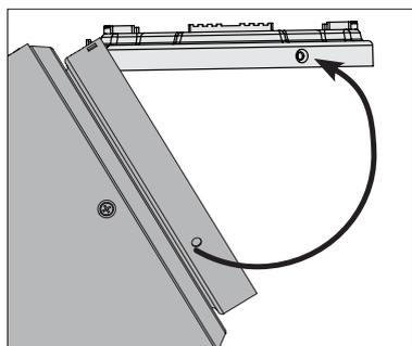
Gire el ventilador hacia arriba y alinee los agujeros de los tornillos de la campana con los agujeros de montaje en la placa de techo.
