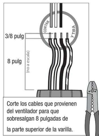
Corte los cables que provienen del ventilador para que sobresalgan 8 pulgadas de la parte superior de la varilla.
