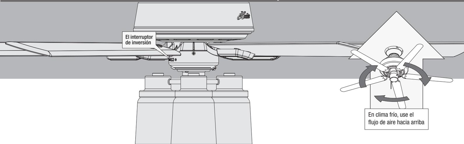
Los ventiladores de techo funcionan en dos direcciones: abajo (giro antihorario) y arriba (rotación en sentido horario). Para cambiar la dirección del flujo de aire, apague el ventilador y deje que se detenga por completo. Deslice el interruptor de inversión en el ventilador a la posición opuesta. Vuelva a encender el ventilador.
