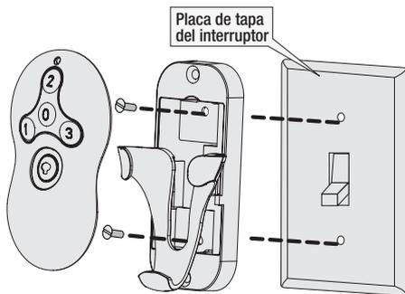
Para instalar el soporte del transmisor, quite los dos tornillos que sujetan la placa de tapa del interruptor. No retire la placa de tapa. Para orientar el soporte, alinee los dos orificios de montaje con los orificios de la placa de tapa. Coloque y apriete los tornillos. No apriete en exceso.
