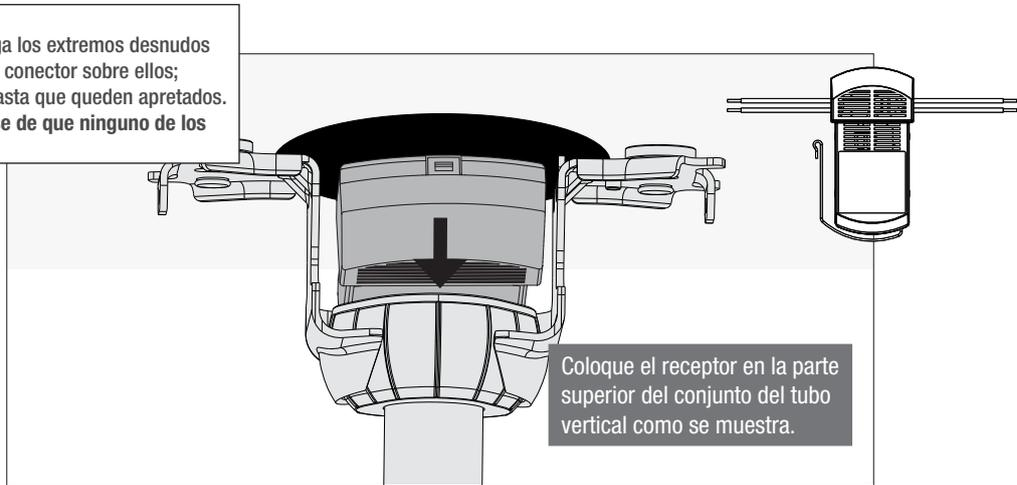
Coloque el receptor en la parte superior del conjunto del tubo vertical como se muestra.
