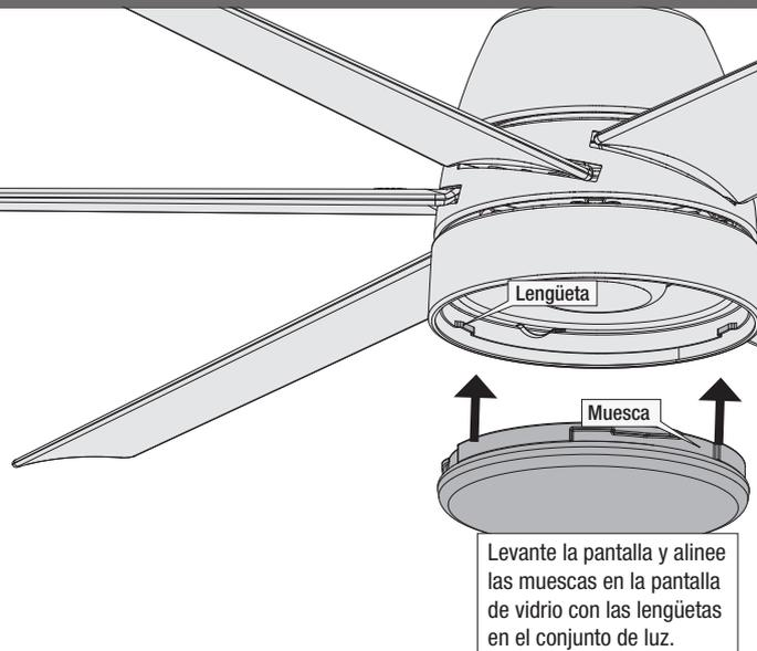
Levante la pantalla y alinee las muescas en la pantalla de vidrio con las lengüetas en el conjunto de luz.
