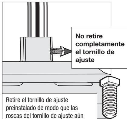
No retire completamente el tornillo de ajuste
