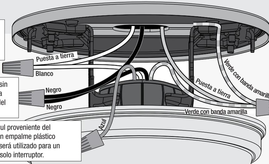
Conecte el cable negro (sin toma a tierra) del techo a los cables negro y azul del ventilador.
