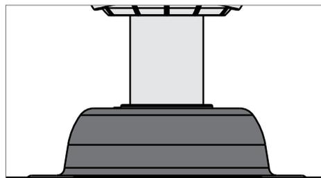
Baje la cubierta del adaptador hasta que descansa a nivel contra el alojamiento del motor.
