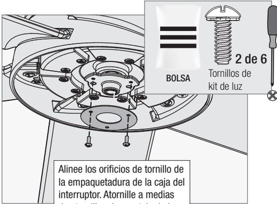
Alinee los orificios de tornillo de la empaquetadura de la caja del interruptor. Atornille a medias dos tornillos de montaje de la caja que están en la bolsa de materiales
