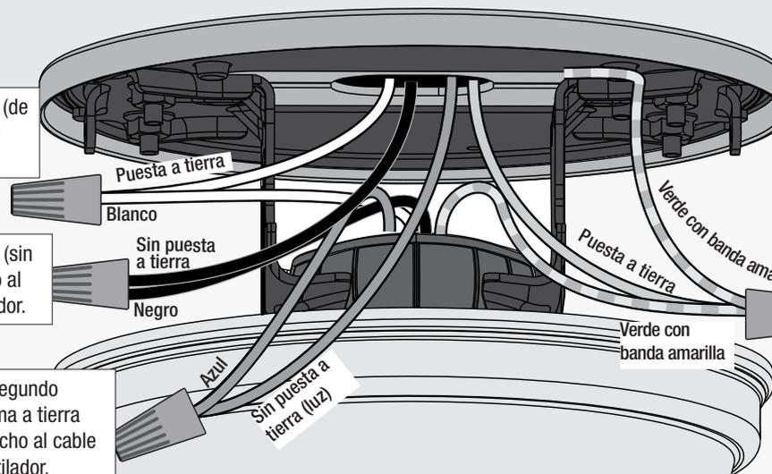
Conecte el cable negro (sin toma a tierra) del techo al cable negro del ventilador.
