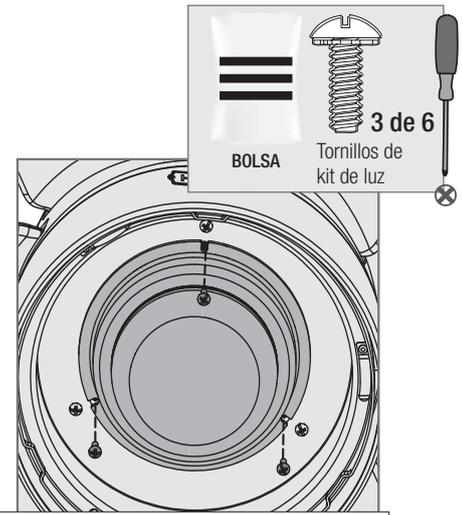
Instale los tres tornillos de caja del interruptor incluidos en la bolsa de materiales
