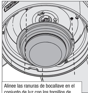
Alinee las ranuras de bocallave en el conjunto de luz con los tornillos de montaje. Asegúrese de que todos los alambres del ventilador y del conjunto de luz estén ajustados dentro del centro del conjunto de luz, y que no estén atascados entre la caja superior del interruptor y el conjunto de luz o colgando de los lados.
