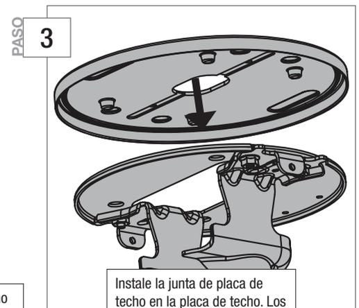
Instale la junta de placa de techo en la placa de techo. Los cuatro orificios en la placa de techo deberían alinearse con los cuatro postes en la junta.
