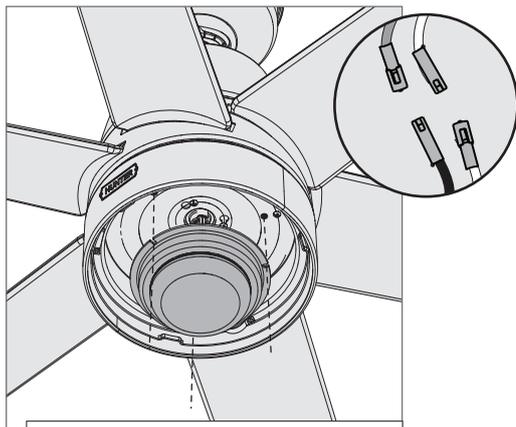
Conecte el cable blanco del ventilador al cable blanco del conjunto de lámparas. Luego, conecte el cable azul del ventilador al cable negro del conjunto de lámparas.
