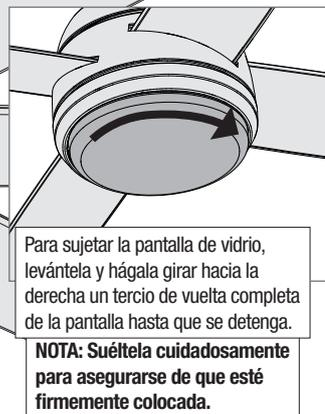
Para sujetar la pantalla de vidrio, levántela y hágala girar hacia la derecha un tercio de vuelta completa de la pantalla hasta que se detenga.
