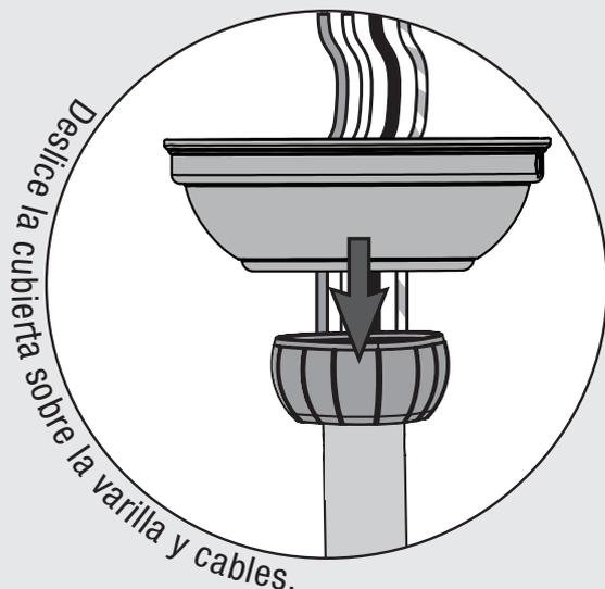
Deslice la cubierta sobre la varilla y cables.
