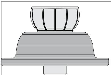
Deslice la cubierta del adaptador hacia el tubo de soporte hasta que descansa sobre la bola de suspensión.
