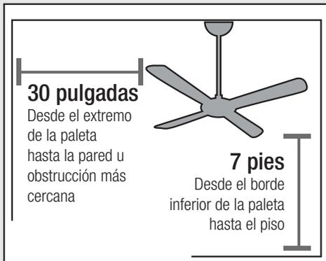
Para techos con altura superior a 3 m, compre por Internet un kit de extensión de cable DC y un tubo de soporte.
