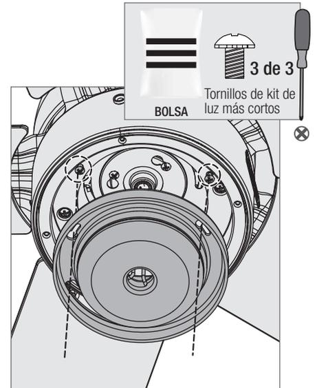
Gire el conjunto de luz en sentido antihorario hasta que los tornillos de ensamblaje de la caja estén firmemente colocados en el extremo angosto de las ranuras de bocallave. Instale el tornillo restante en la caja
