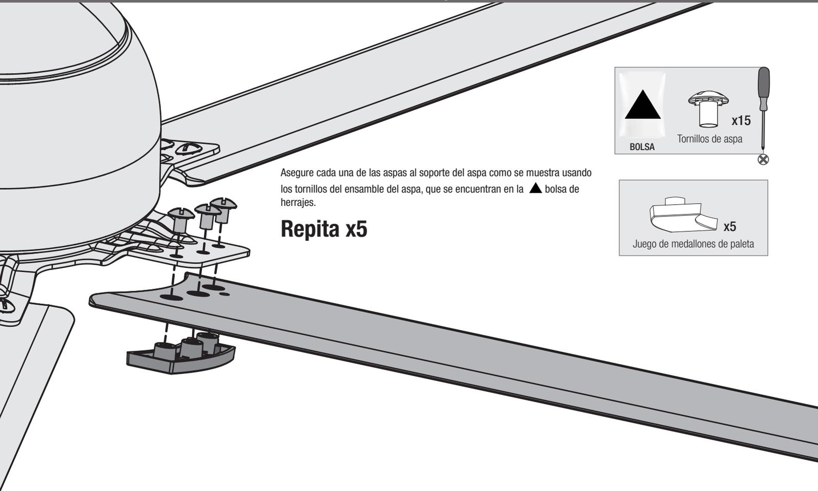
Asegure cada una de las aspas al soporte del aspa como se muestra usando los tornillos del ensamble del aspa, que se encuentran en la ▲ bolsa de herrajes.
