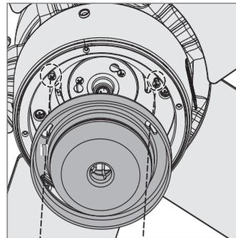
Alinee las ranuras de bocallave en el conjunto de luz con los tornillos de montaje. Asegúrese de que todos los alambres del ventilador y del conjunto de luz estén ajustados dentro del centro del conjunto de luz, y que no estén atascados entre la caja superior del interruptor y el conjunto de luz o colgando de los lados.
