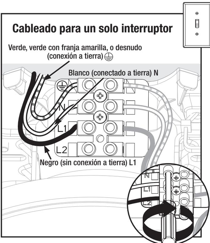
Conecte los alambres procedentes del techo al bloque de terminales (ubicado en el costado del soporte de campana) y apriete utilizando un destornillador de cabeza plana (incluido).
