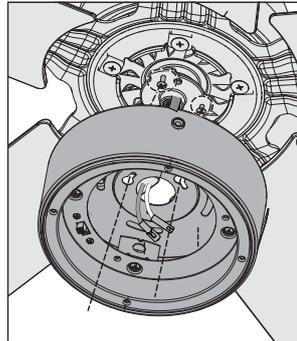
Pase la clavija del alambre a través del agujero central de la caja superior del interruptor, luego envuelva la ranura de bocallave alrededor de los tornillos y gire en sentido antihorario.
