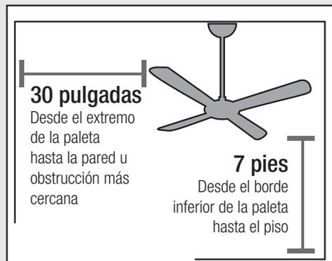
Para techos con altura superior a 3 m, compre por Internet un kit de extensión de cable DC y un tubo de soporte.
