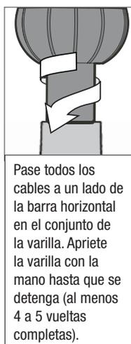
Pase todos los cables a un lado de la barra horizontal en el conjunto de la varilla. Apriete la varilla con la mano hasta que se detenga (al menos 4 a 5 vueltas completas).
