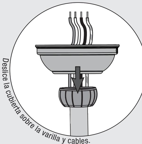
Deslice la cubierta sobre la varilla y cables.
