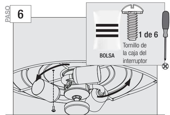
Gire el conjunto de lámpara en sentido contrario de las manecillas del reloj hasta que los tornillos del conjunto de lámpara estén firmemente colocados en el extremo angosto de las ranuras tipo bocallave. Instale el tercer tornillo ≡ y apriete firmemente todos los tres tornillos.
