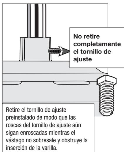
No retire completamente el tornillo de ajuste
