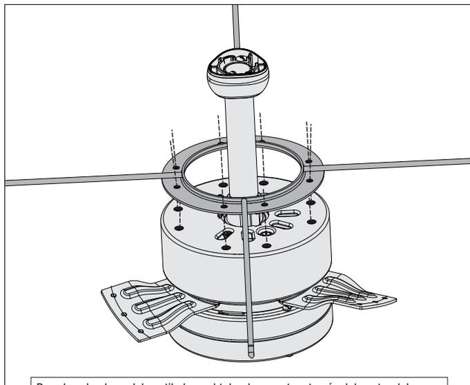
Pase los alambres del ventilador y el tubo de soporte a través del centro del conjunto de soporte. Alinee los orificios para tornillo, ubicados en la parte superior del alojamiento del motor, con los orificios para tornillo del conjunto de soporte.
