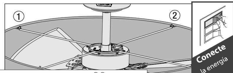
Comience con los orificios de las lengüetas ① ② de la persiana exterior más alejados de usted e instáelos hacia usted. Alinee los orificios, ubicados en las pestañas de la pantalla exterior, con los ganchos del conjunto de soporte. Asegure la pantalla exterior al conjunto de soporte insertando los ganchos del conjunto de soporte dentro de las pestañas de la pantalla exterior.
