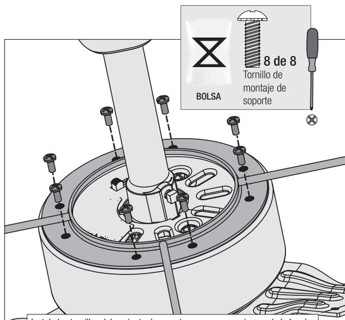
Instale los tornillos del conjunto de soporte, que se encuentran en la bolsa de tornillería X. Apriete todos los tornillos.
