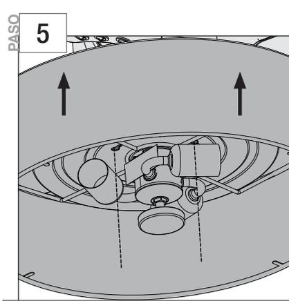
Alinee las ranuras tipo bocallave, ubicadas en la carcasa del conjunto de lámpara, con los dos tornillos. Asegúrese de que todos los cables del ventilador y del conjunto de lámparas estén ajustados dentro del centro del conjunto de lámparas, y que no estén atascados entre la caja superior del interruptor y el conjunto de lámparas o colgando de los lados.
