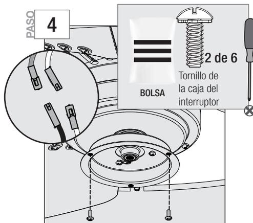
Instale parcialmente dos tornillos del conjunto de lámpara, que se encuentran en la bolsa de tornillería ≡, hasta la mitad de su inserción dentro de la caja superior del interruptor. No importa cuáles orificios para tornillo usted elija. Conecte los conectores de una sola clavija del conjunto de lámpara con los conectores del ventilador. Conecte los alambres blancos entre sí. Conecte los alambres azul y negro entre sí.
