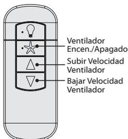
El botón de ENCENDIDO/APAGADO (On/Off) enciende o apaga el ventilador. Ajuste la velocidad del ventilador a través de los botones direccionales "Aumentar velocidad" o "Disminuir velocidad".
