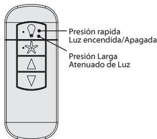
Presione brevemente el botón de luz para apagar y encender las luces. Mantenga el botón de luz presionado para aumentar o disminuir la intensidad lumínica.
