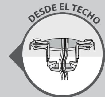
**CONECTE LOS CABLES DEL RECEPTOR AL VENTILADOR** - Usando los conectores de cable anaranjado, conecte el cable amarillo desde el receptor hacia el cable negro proveniente del ventilador. Conecte el cable azul del receptor al cable azul (o posiblemente negro con tira blanca) proveniente del ventilador.
