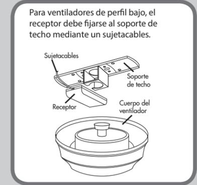
**Elija el sistema de suspensión que más se parezca al que utiliza su ventilador y monte el receptor y conecte los cables según se indica.**
