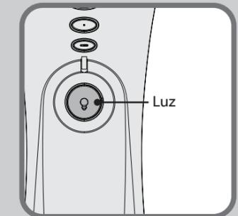
Presione brevemente el botón de luz para encender y apagar las luces. Mantenga el botón de luz presionado para aumentar o disminuir la intensidad lumínica.
