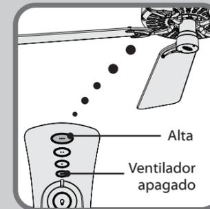
**Nota:** El control remoto debe estar sincronizado antes de operar el ventilador.
