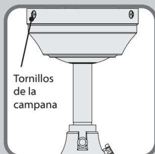
Si su ventilador ya está instalado y la campana es sostenida por tres tornillos cerca del techo como se muestra, siga las **INSTRUCCIONES DE ENSAMBLE TIPO C.**
