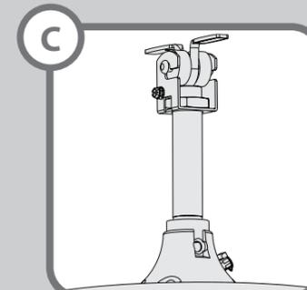
Vuelva a instalar el ventilador de acuerdo al manual de instalación incluido con el ventilador pero no instale la placa de suspensión, la campana, ni el inserto de la campana. Vuelva a conectar el cable de tierra de acuerdo al manual del ventilador. Continúe con las instrucciones de cableado.
