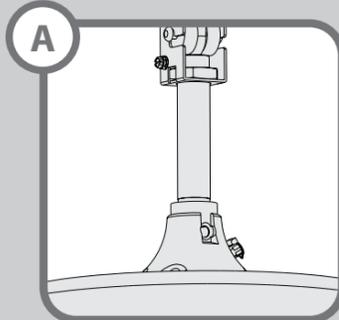
Instale el ventilador de acuerdo al manual del ventilador, pero no instale la campana. Instale el cable de tierra de acuerdo a las instrucciones del manual del ventilador. Continúe con las instrucciones de cableado.
