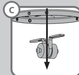
Retire el soporte en U y la placa de suspensión del techo.
