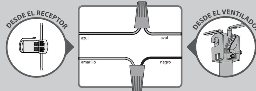
**CONECTE LOS CABLES DEL RECEPTOR AL VENTILADOR** - Usando los conectores de cable anaranjado, conecte el cable amarillo desde el receptor hacia el cable negro proveniente del ventilador. Conecte el cable azul del receptor al cable azul (o posiblemente negro con tira blanca) proveniente del ventilador.
