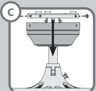
Retire los tres tornillos de la campana. Baje la campana y el inserto de la campana. Con los cables expuestos, puede que resulte útil anotar las conexiones existentes o sacar una foto digital como referencia. Quite los conectores para cables que conectan los cables desde la caja de salida hacia el ventilador. Desenganche el ventilador del techo.
