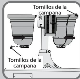
Empuje las dos mitades de la campana desde el kit uniéndolas alrededor del sistema de suspensión. Asegúrese de que el receptor está colocado adentro. Instale parcialmente los tornillos de la campana desde el kit hacia los orificios para tornillos. Deslice la campana hacia arriba y cerca del techo. Apriete los cuatro tornillos.
