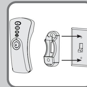
Para instalar el soporte del transmisor, quite los dos tornillos que sujetan la placa de tapa del interruptor. No retire la placa de tapa. Para orientar el soporte, alinee los dos orificios de montaje con los orificios de la placa de tapa. Coloque y apriete los tornillos. No apriete en exceso.
