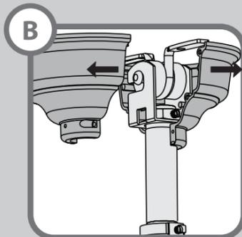
Retire las dos mitades de la campana. Con los cables expuestos, puede ser que resulte útil anotar las conexiones existentes o sacar una foto digital como referencia. Quite los conectores para cables que conectan los cables desde la caja de salida hacia el ventilador, pero deje conectado el cable de tierra. Continúe con las instrucciones de cableado.
