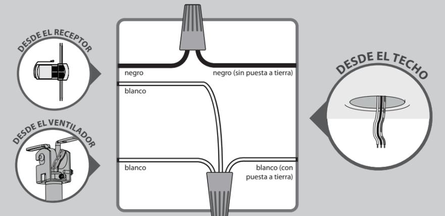
**CONECTE LOS CABLES DEL RECEPTOR Y VENTILADOR A LOS CABLES DE LA CAJA DE SALIDA** - Usando los conectores de cable anaranjados, conecte el cable negro (no aterrizado) desde el techo hacia el cable negro del receptor. Conecte el alambre blanco (aterizado) desde el techo al cable blanco del receptor y al cable blanco del ventilador.
