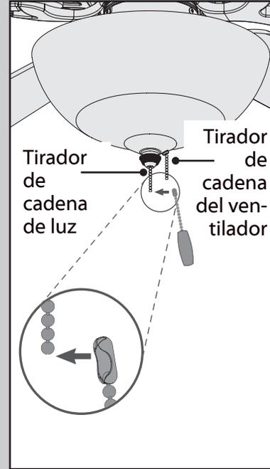
Coloque el pendiente de cadena adecuado en cada una de las cadenas cortas que salen de la cubierta ornamental y de la tapa de la cubierta ornamental. El tirador de cadena del ventilador controla la velocidad: alta, media, baja, y apagada. El tirador de cadena de luz controla el accesorio de luz: encendido y apagado.
