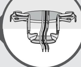
Para evitar posibles choques eléctricos, antes de instalar su ventilador, desconecte la alimentación apagando los interruptores automáticos que alimentan a la caja de salida asociados con el interruptor de pared.
