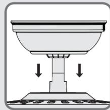
**4** **De los sistemas de suspensión que se muestran a la derecha elija el que más se parezca al que utiliza su ventilador y coloque el receptor según se muestra.**
