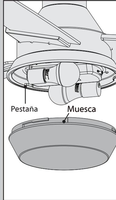
Ubique las muescas del borde externo de la pantalla de vidrio de modo que se alineen con las pestañas en la superficie interna del borde del artefacto de iluminación.
