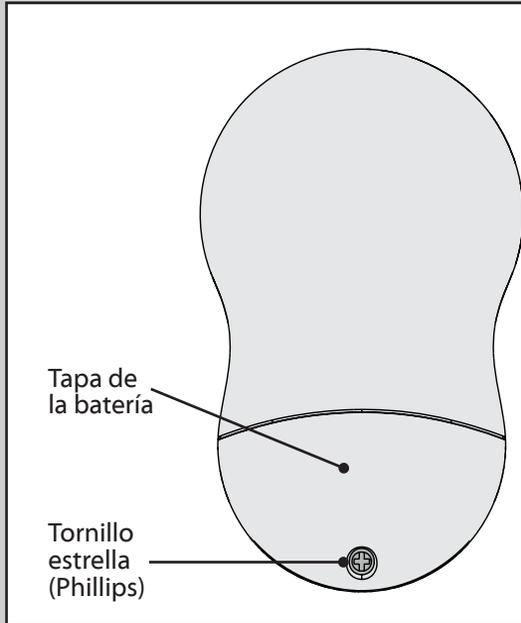
Para acceder al compartimiento de la batería quite el pequeño tornillo estrella (Phillips) que fija la tapa del compartimiento al conjunto del transmisor. La batería debe instalarse con el lado positivo (+) hacia arriba. Reemplace la batería CR2032 según sea necesario.
