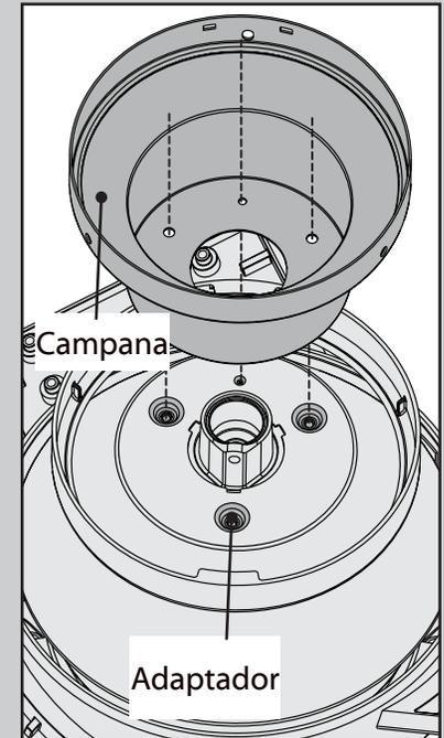
Coloque la campana en la tapa superior. Asegure todos los cuatro orificios para tornillos estén alineados hacia arriba con los orificios para tornillos en la tapa superior y en el adaptador.
