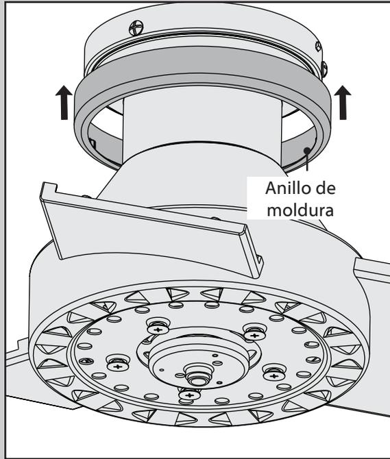
Con las dos manos empuje el anillo de la moldura de campana hasta la parte superior de la campana. Escuchará un clic y el anillo de la moldura de campana quedará asegurado en posición.
