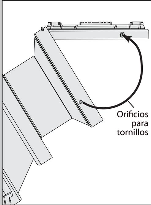
Gire el ventilador hacia arriba y alinee los agujeros de los tornillos de la campana con los agujeros de montaje en la placa de techo.
