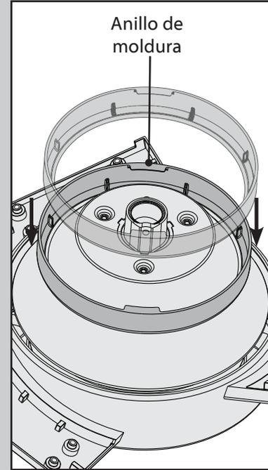
Coloque el anillo de moldura en la tapa superior.
