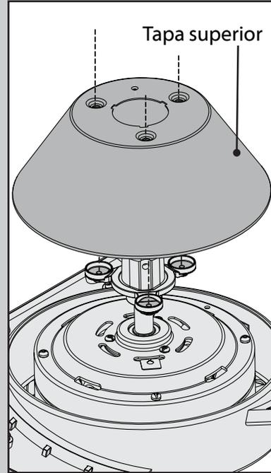
Coloque la tapa superior sobre el alojamiento del motor de modo que los orificios en la tapa superior se alineen con los orificios en el alojamiento del motor.
