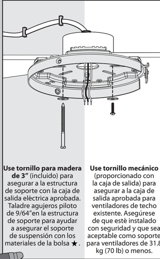
**Use tornillo para madera de 3"** (incluido) para asegurar a la estructura de soporte con la caja de salida eléctrica aprobada. Taladre agujeros piloto de 9/64" en la estructura de soporte para ayudar a asegurar el soporte de suspensión con los materiales de la bolsa ★.
