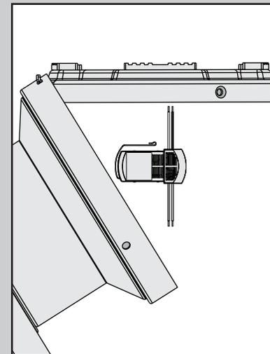
Coloque el receptor dentro de la campana. Asegúrese que los cables se mantengan conectados.
