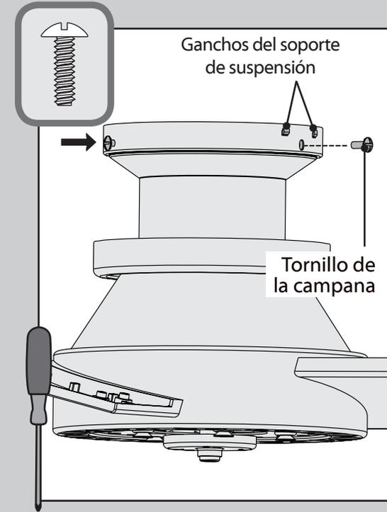
⊗ Instale parcialmente un tornillo de la campana, encontrado en la ● bolsa de materiales, que está entre los ganchos del soporte de suspensión. Cuando los orificios estén bien alineados, apriete firmemente los tres tornillos de la campana.
