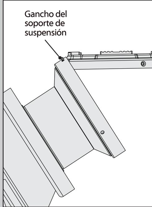
Coloque las ranuras sobre los ganchos del soporte de suspensión para colgar el ventilador.
