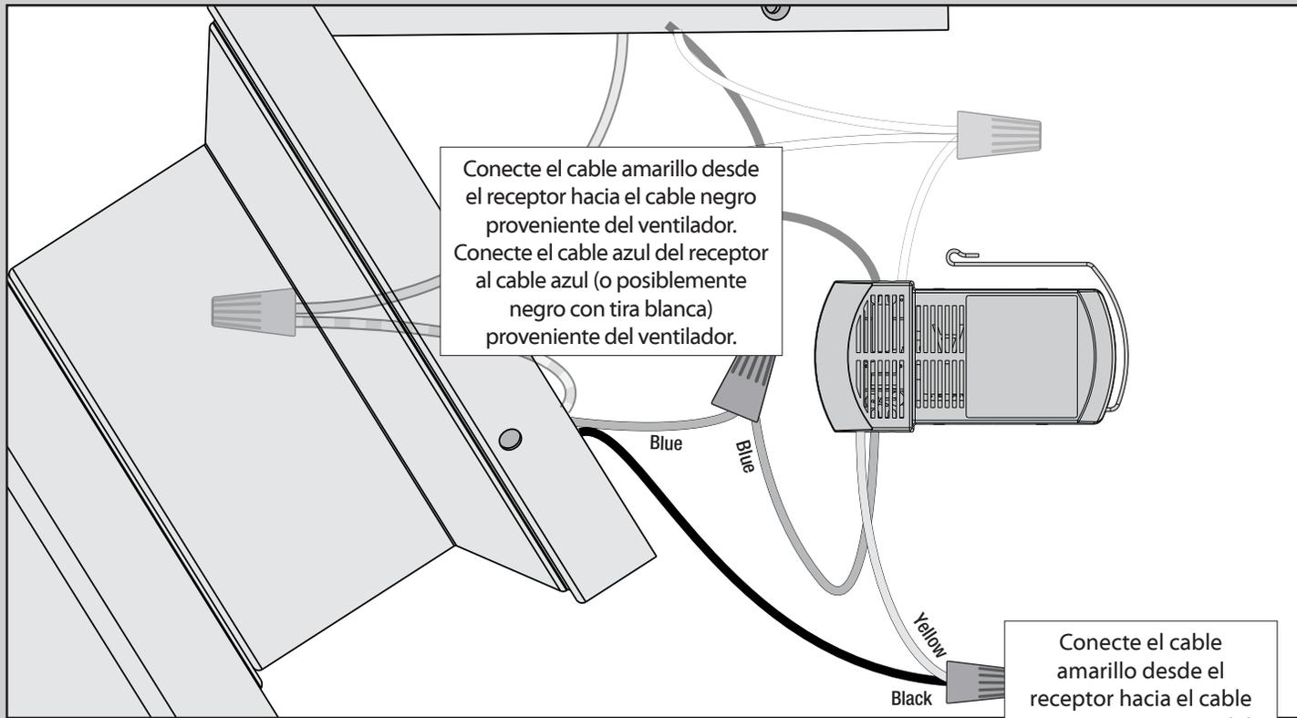
Conecte el cable amarillo desde el receptor hacia el cable negro proveniente del ventilador.
