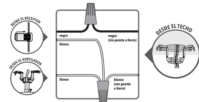
Gire los empalmes hacia arriba y presínelos cuidadosamente hacia atrás a través del soporte de suspensión dentro de la caja de salida. Separe los alambres, con los alambres puestos a tierra a un lado de la caja de salida y los alambres no puestos a tierra al otro lado de la caja de salida.
