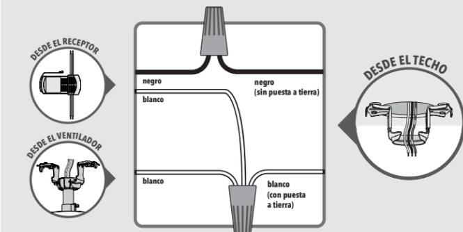
**!** Gire los empalmes hacia arriba y presiónelos cuidadosamente hacia atrás a través del soporte de suspensión dentro de la caja de salida. Separe los alambres, con los alambres puestos a tierra a un lado de la caja de salida y los alambres no puestos a tierra al otro lado de la caja de salida.
