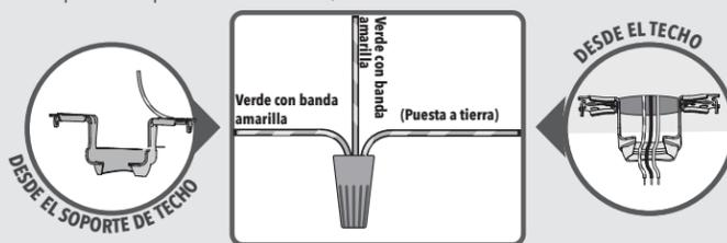
**5 Conecte los cables del receptor al ventilador**
