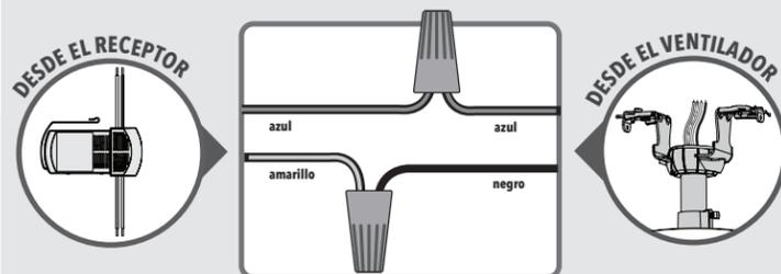
**6 Conectando cables del receptor y del ventilador al techo**
