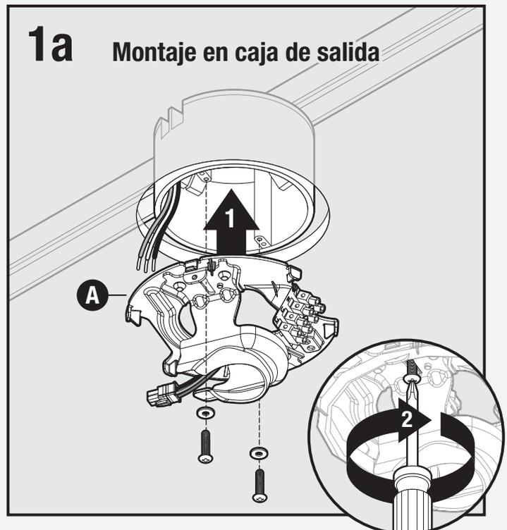
Instale el soporte (A) de campana a la caja de salida. Asegure con tornillos para metal y arandelas (suministrados con la caja de salida).
