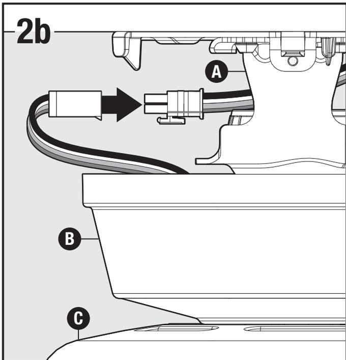
Conecte el manajo de alambres procedente del soporte (A) de campana al manajo de alambres procedente del cuerpo del ventilador (C).
