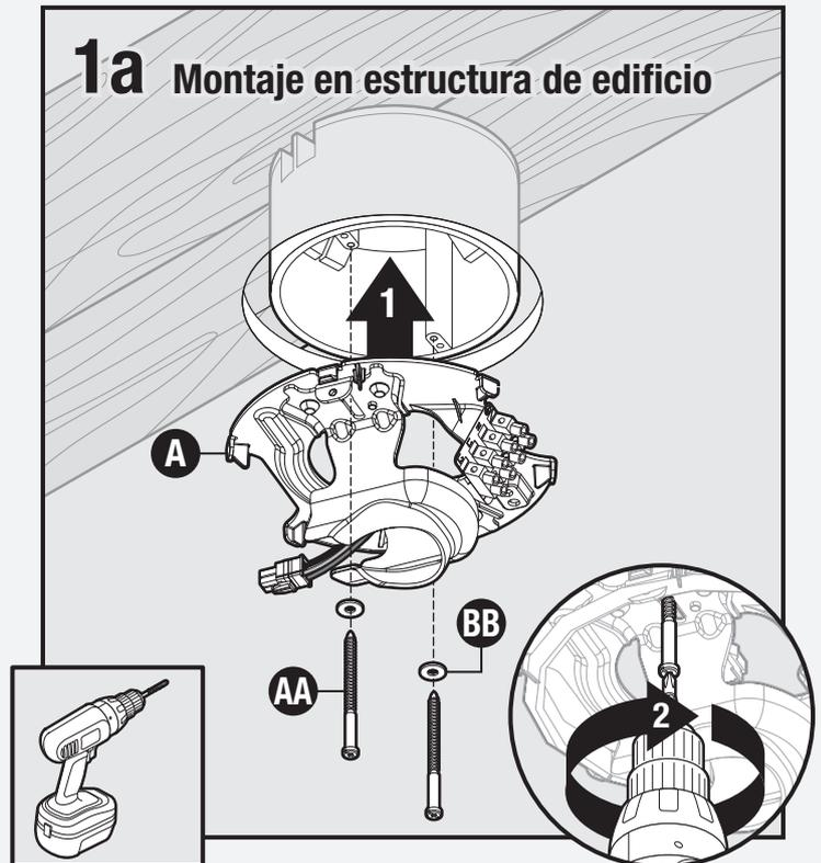
Utilizando los tornillos para madera (AA) y arandelas (BB) incluidos, instale el soporte (A) de campana a través de la caja de salida en la estructura del edificio. Taladrar orificios piloto de 9/64" en la estructura del edificio ayudará a asegurar el soporte (A) de campana.
