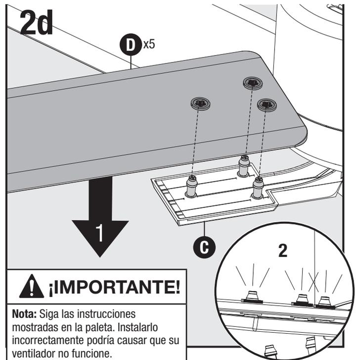
Instale una paleta de colocación a presión en los sujetadores a presión ubicados en el soporte de paleta pre-instalado (C). Repita para las paletas restantes (D).
