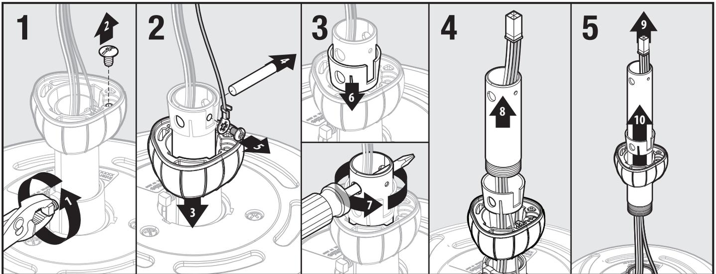
1. Afloje el tornillo de fijación (1) y remueva el tornillo (2) de la bola.
