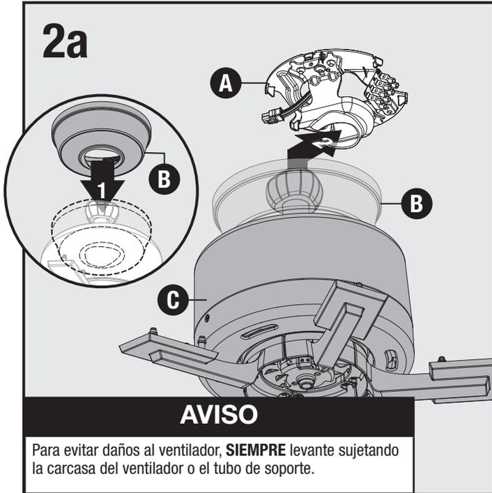
Instale la campana (B) de colocación a presión sobre el tubo de soporte en el cuerpo del ventilador (C). Coloque la bola del tubo de soporte en la ranura del soporte (A) de campana con soporte incorporado de instalación en techo.
