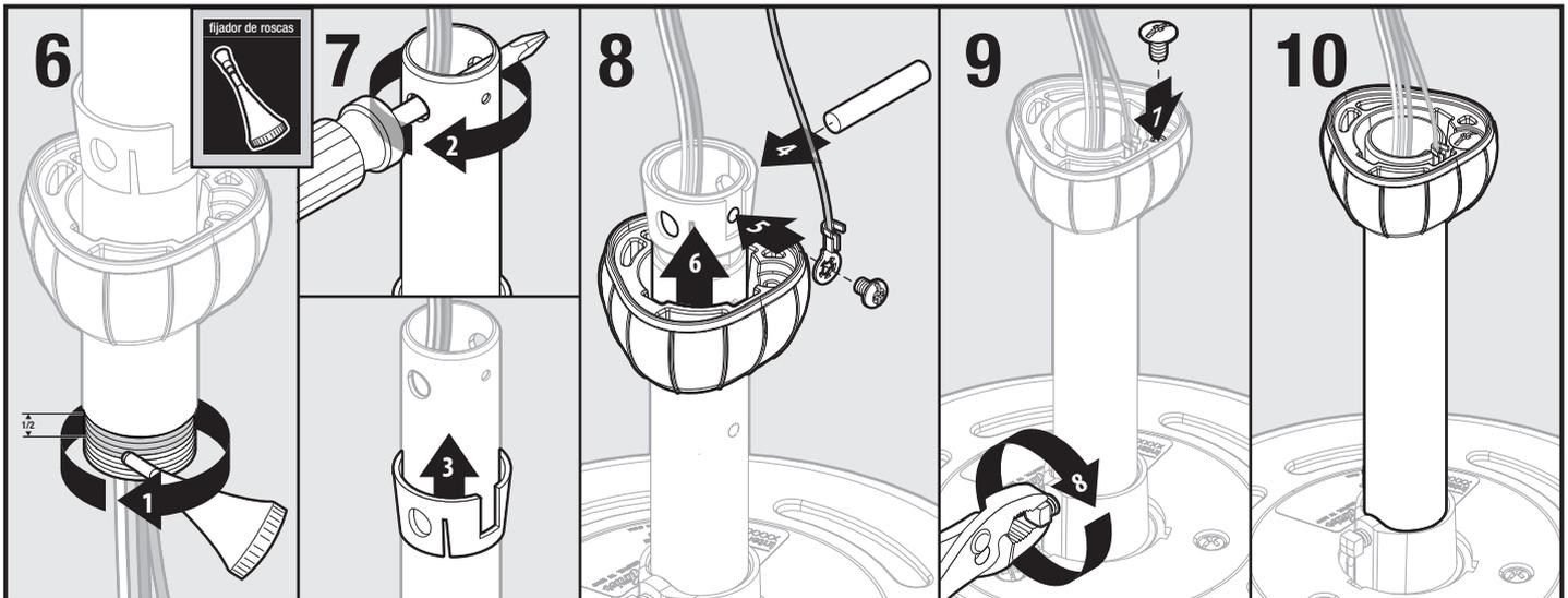
6. Después de limpiar el área de rosca del tubo, aplique 1 ml de fijador de roscas a la mitad inferior del tubo de soporte (1).
