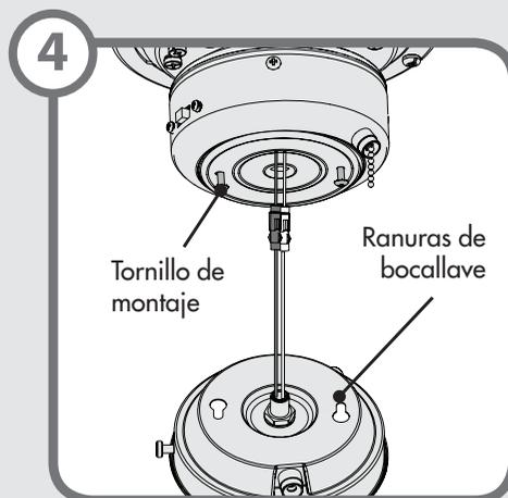
Levante el juego de luz para que coincida con la caja inferior del interruptor. Envuelva las ranuras de bocallave alrededor de los tornillos y gire en sentido contrario a las agujas del reloj. Apriete los tornillos.
