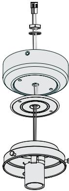
Pase los cables a través del orificio central de la caja del interruptor, la arandela y la tuerca. Empuje el orificio central de la empaquetadura sobre la varilla roscada del juego de luz. A continuación instale la caja del interruptor haciéndola girar en sentido horario sobre la varilla roscada. Instale la arandela y la tuerca en la varilla roscada y apriete firmemente.
