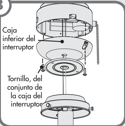
Levante la caja inferior del interruptor de modo que los orificios de tornillo queden alineados con los orificios situados en la caja superior del interruptor. Instale los tornillos de la caja del interruptor y apriételes firmemente.
