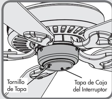
Si la tapa de la caja del interruptor de su ventilador se parece a ésta, quite los tornillos de la tapa con un destornillador estrella (Phillips). A continuación siga las instrucciones de **MONTAJE TIPO A** de las páginas 4-5.
