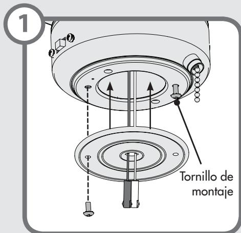
Pase los cables a través del orificio central situado en la empaquetadura. A continuación instale parcialmente los dos tornillos de montaje a través de la empaquetadura en la parte inferior de la caja inferior del interruptor. Presione la empaquetadura al ras de la caja inferior del interruptor.
