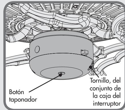
Si la tapa de la caja del interruptor de su ventilador se parece a ésta, quite toda la caja del interruptor; para ello deberá quitar los tornillos de la caja del interruptor con un destornillador estrella (Phillips). Quite el botón de tapón mediante un destornillador estándar. A continuación siga las instrucciones de **MONTAJE TIPO C** de las páginas 8-9.
