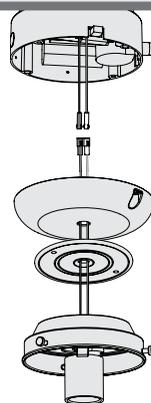
Haga pasar los cables del orificio central en el empaque y la caja del interruptor. A continuación use los conectores de pin individual para conectar el cable negro o azul del ventilador con el cable negro del juego de luz. Conecte el cable blanco del ventilador al cable blanco del juego de luz.
