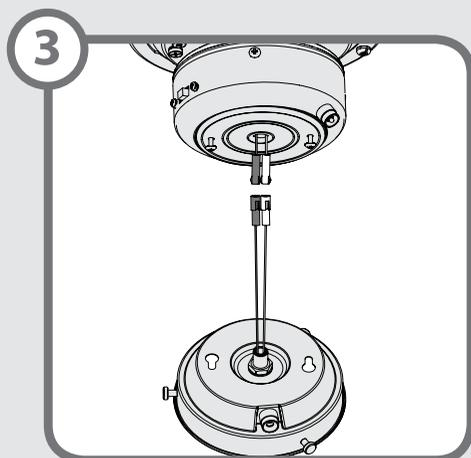
Use los conectores de pin individual para conectar el cable negro o azul del ventilador con el cable negro del juego de luz. Conecte el cable blanco del ventilador al cable blanco del juego de luz.
