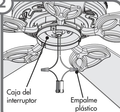
Si su ventilador no posee conectores de pines en los cables provenientes de la caja del interruptor, instale el manajo de cables proporcionado. Utilice los conectores de cables proporcionados para conectar el cable blanco del ventilador con el cable blanco del manajo de cables y conecte el cable negro o azul del ventilador con el cable negro del manajo de cables.
