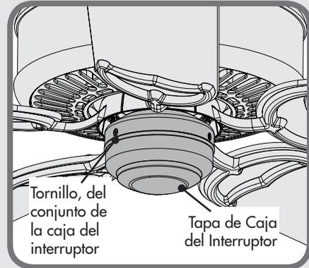
Si la tapa de la caja del interruptor de su ventilador se parece a ésta, quite toda la caja del interruptor; para ello deberá quitar los tornillos de la caja del interruptor con un destornillador estrella (Phillips). Quite los dos tornillos de la tapa desde el interior de la caja del interruptor. Reinstale la caja del interruptor. Apriete los tornillos de la caja del interruptor. A continuación siga las instrucciones de **MONTAJE TIPO A** de las páginas 4-5.
