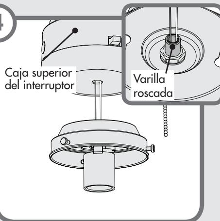
Levante el juego de luz y meta los cables en el orificio de la caja del interruptor. Instale el vástago central del juego de luz en la caja inferior del interruptor; para ello, gire la varilla roscada en sentido horario para insertarla en el orificio roscado. Continúe girando hasta que quede apretada.
