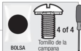
Instale los dos tornillos de cubierta restantes manteniendo la cubierta del cuerpo del ventilador hacia la placa de montaje de techo. Apriete firmemente los cuatro tornillos.
