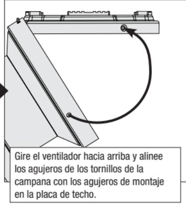
Gire el ventilador hacia arriba y alinee los agujeros de los tornillos de la campana con los agujeros de montaje en la placa de techo.
