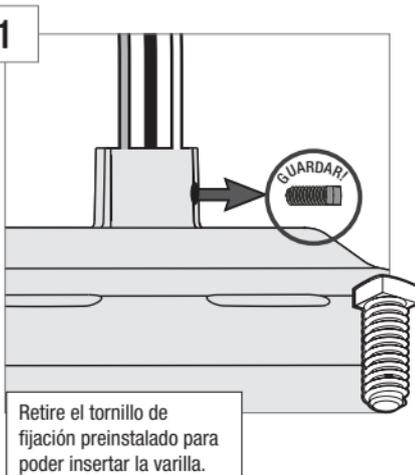
Retire el tornillo de fijación preinstalado para poder insertar la varilla.
