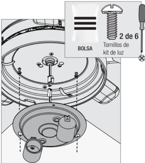
Instale parcialmente dos de los tornillos de las cajas del interruptor que están en la bolsa de materiales. No importa cuáles agujeros escoja. Conecte las clavijas de las cajas superior e inferior del interruptor. Asegúrese de alinear las marcas de color de los conectores.
