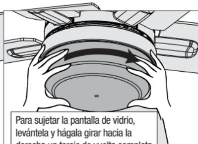
Para sujetar la pantalla de vidrio, levántela y hágala girar hacia la derecha un tercio de vuelta completa de la pantalla hasta que se detenga.
