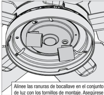
Alinee las ranuras de bocallave en el conjunto de luz con los tornillos de montaje. Asegúrese de que todos los alambres del ventilador y del conjunto de luz estén ajustados dentro del centro del conjunto de luz, y que no estén atascados entre la caja superior del interruptor y el conjunto de luz o colgando de los lados.
