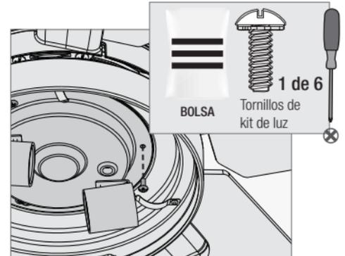
Gire el conjunto de luz en sentido antihorario hasta que los tornillos de ensamble de la caja estén firmemente colocados en el extremo angosto de las ranuras de bocallave. Instale el tornillo restante en la caja. Apriete los tres tornillos firmemente.
