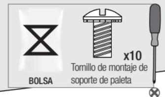
Acople sin emplear mucha fuerza los soportes de paleta al motor con los tornillos de la bolsa de materiales X, luego apriete con firmeza, cuando ambos tornillos estén acoplados.
