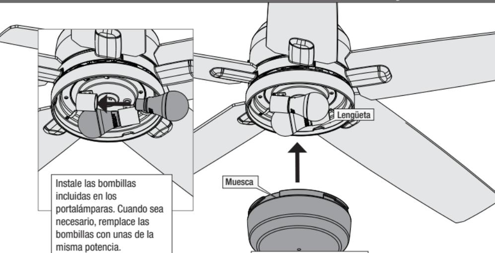
Instale las bombillas incluidas en los portalámparas. Cuando sea necesario, reemplace las bombillas con unas de la misma potencia.
