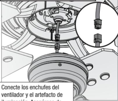
Conecte los enchufes del ventilador y el artefacto de iluminación. Asegúrese de alinear las marcas de color de los conectores.
