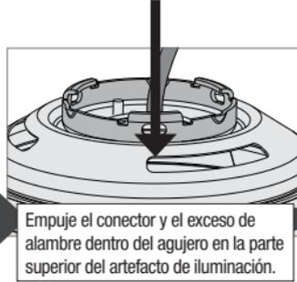
Empuje el conector y el exceso de alambre dentro del agujero en la parte superior del artefacto de iluminación.
