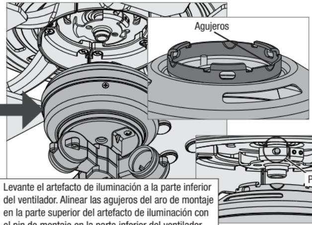
Levante el artefacto de iluminación a la parte inferior del ventilador. Alinear los agujeros del aro de montaje en la parte superior del artefacto de iluminación con el pin de montaje en la parte inferior del ventilador.
