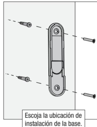
Si está instalando sobre un panel de yeso, perforo dos orificios de 9/64" de ancho usando el soporte de la base como una guía. Martille con cuidado las anclas para panel de yeso incluidas en los orificios previamente perforados.
