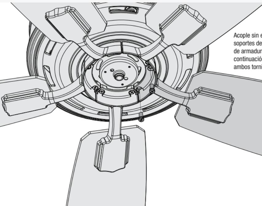
Acople sin emplear mucha fuerza los soportes de paleta al motor con los tornillos de armadura de soporte de paleta y a continuación apriete con firmeza una vez que ambos tornillos estén acoplados.
