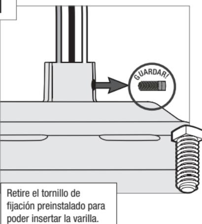
Retire el tornillo de fijación preinstalado para poder insertar la varilla.
