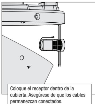
Coloque el receptor dentro de la cubierta. Asegúrese de que los cables permanezcan conectados.
