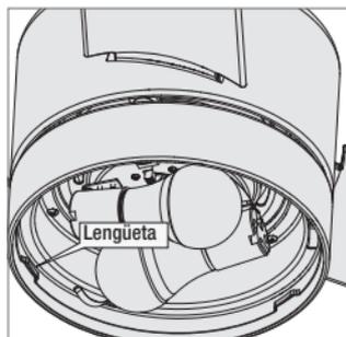
Levante la pantalla y alinee las muescas en la pantalla de vidrio con las lengüetas en el conjunto de luz.
