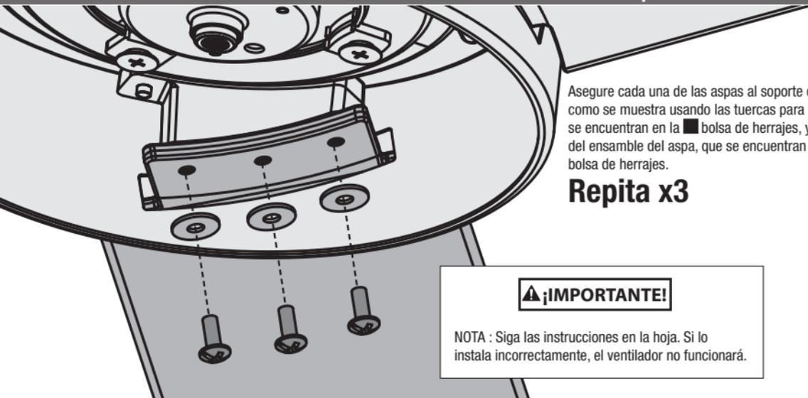
Asegure cada una de las aspas al soporte del asa como se muestra usando las tuercas para el asa que se encuentran en la bolsa de herrajes, y los tornillos del ensamble del asa, que se encuentran en la bolsa de herrajes.
