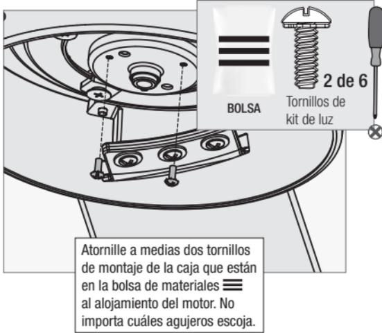
Atornille a medias dos tornillos de montaje de la caja que están en la bolsa de materiales
