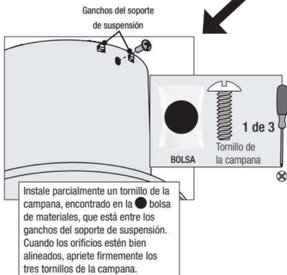
Instale parcialmente un tornillo de la campana, encontrado en la bolsa de materiales, que está entre los ganchos del soporte de suspensión. Cuando los orificios estén bien alineados, apriete firmemente los tres tornillos de la campana.
