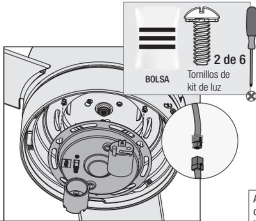
Instale parcialmente dos de los tornillos de luz que están en la bolsa
