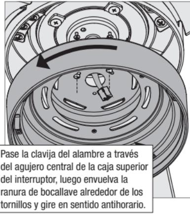
Pase la clavija del alambre a través del agujero central de la caja superior del interruptor, luego envuelva la ranura de bocallave alrededor de los tornillos y gire en sentido antihorario.
