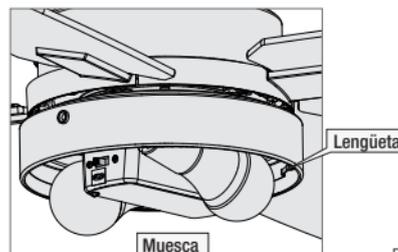
Levante la pantalla y alinee las muescas en la pantalla de vidrio con las lengüetas en el conjunto de luz.
