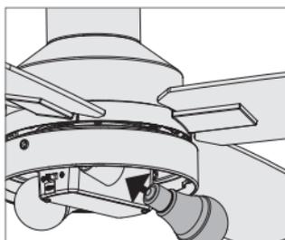
Instale las bombillas incluidas en los portalámparas. Cuando sea necesario, reemplace las bombillas con unas de la misma potencia.
