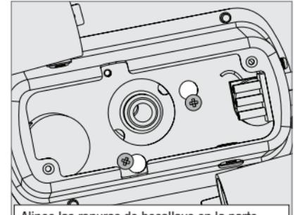
Alinee las ranuras de bocallave en la parte superior del conjunto de lámparas con los tornillos de ensamble parcialmente instalados. Envuelva los orificios de bocallave alrededor de los tornillos y gire en sentido contrario de las manecillas.
