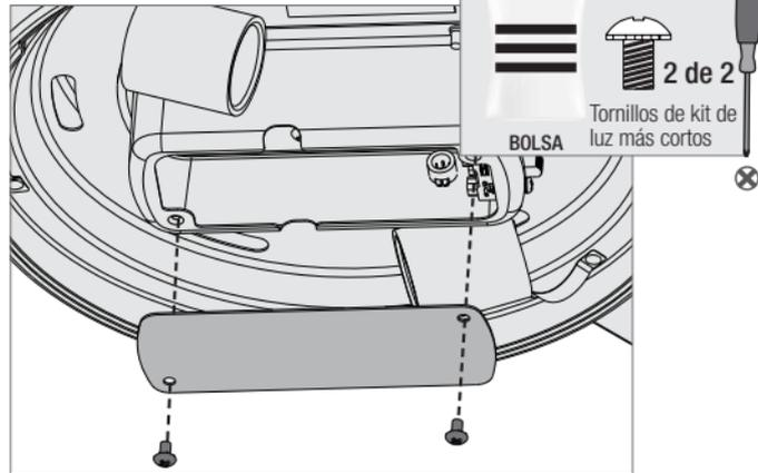
Empuje cuidadosamente todos los componentes de la caja del interruptor en la caja del interruptor, luego instale la placa de la caja del interruptor usando dos tornillos de ensamble del conjunto de lámparas que se encuentran en la
