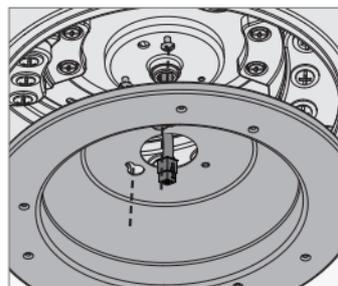
Haga pasar el enchufe de los cables a través del orificio central de la caja superior del interruptor. Alinee las ranuras perforadas en la caja superior del interruptor con los dos tornillos que acaba de instalar. Levante la caja superior del interruptor para que las ranuras perforadas se introduzcan en los dos tornillos, y haga girar en dirección contraria a las agujas del reloj para fijar en posición la caja superior del interruptor.
