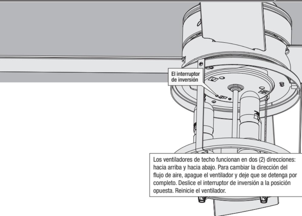
Los ventiladores de techo funcionan en dos (2) direcciones: hacia arriba y hacia abajo. Para cambiar la dirección del flujo de aire, apague el ventilador y deje que se detenga por completo. Deslice el interruptor de inversión a la posición opuesta. Reinicie el ventilador.
