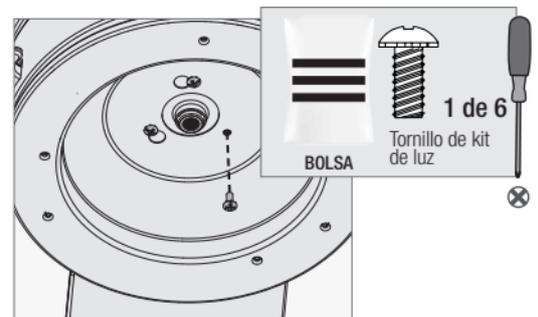
Inserte el tercer tornillo en su lugar, que se encuentra en la bolsa de tornillería (≡), y apriete firmemente todos los tres tornillos.
