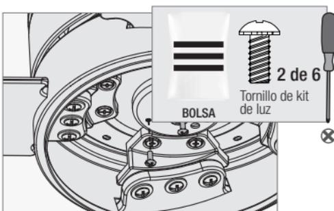
Instale parcialmente dos tornillos del conjunto de lámparas que se encuentran en la bolsa de tornillería ≡ hasta la mitad de la placa del adaptador, como se muestra. No importa cuáles agujeros escoja.
