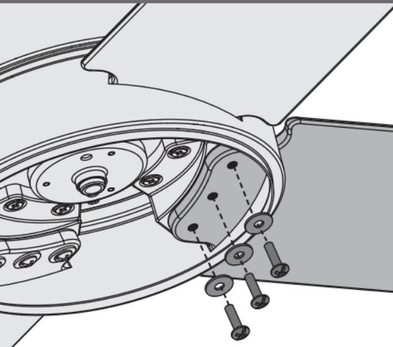
Asegure cada una de las aspas al soporte del aspa como se muestra usando las tuercas para el aspa que se encuentran en la ■ bolsa de herrajes, y los tornillos del ensamble del aspa, que se encuentran en la ▲ bolsa de herrajes.
