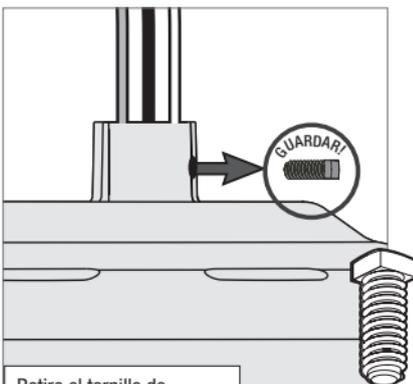
Retire el tornillo de fijación preinstalado para poder insertar la varilla.
