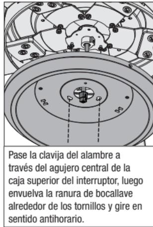
Pase la clavija del alambre a través del agujero central de la caja superior del interruptor, luego envuelva la ranura de bocallave alrededor de los tornillos y gire en sentido antihorario.
