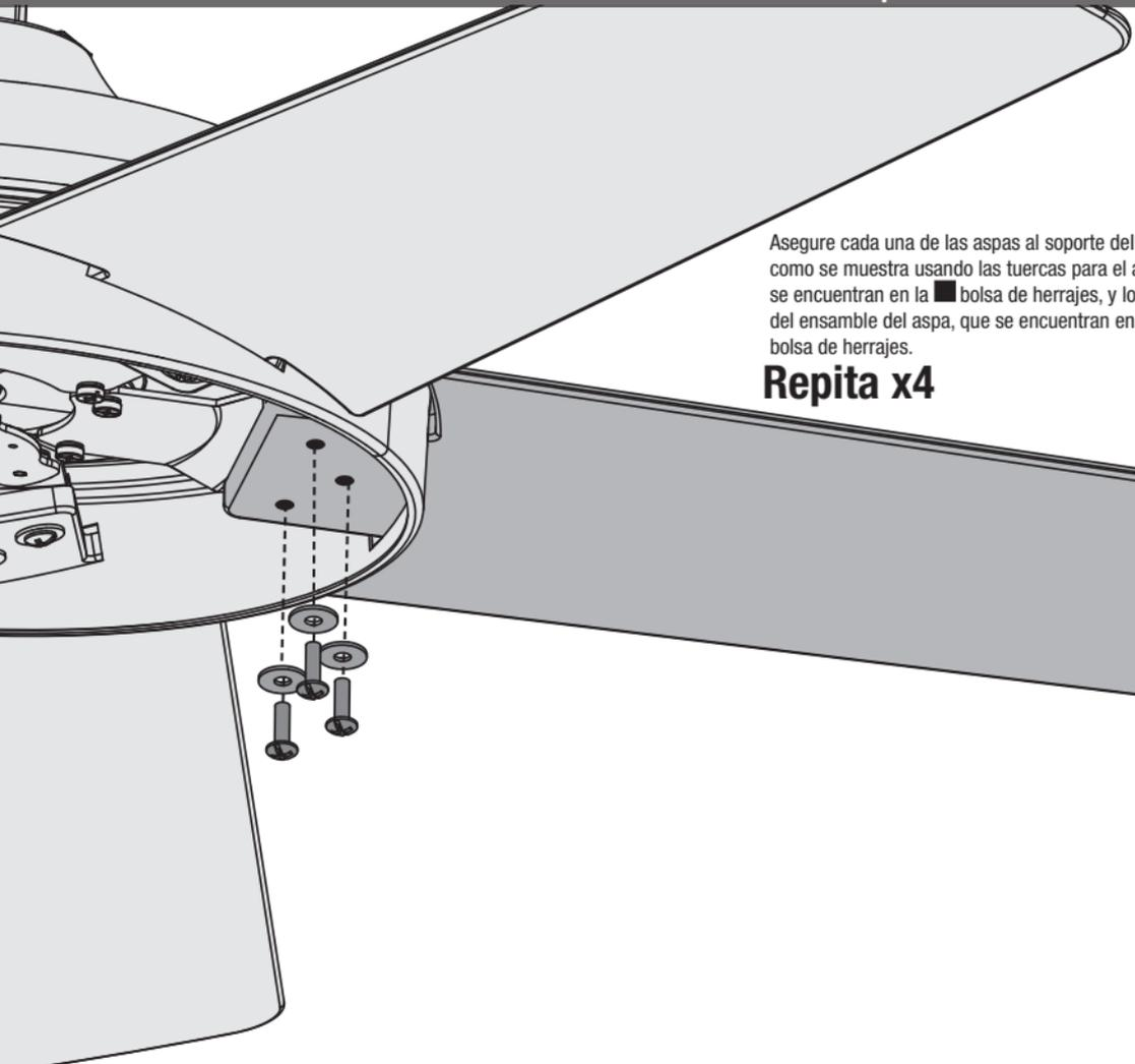
Asegure cada una de las aspas al soporte del aspa como se muestra usando las tuercas para el aspa que se encuentran en la ■ bolsa de herrajes, y los tornillos del ensamble del aspa, que se encuentran en la ▲ bolsa de herrajes.
