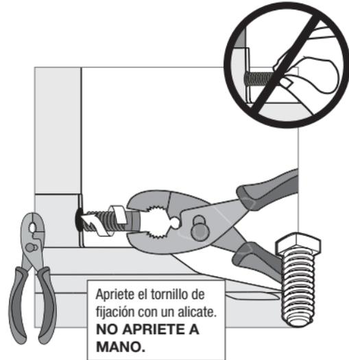
Apriete el tornillo de fijación con un alicate.
