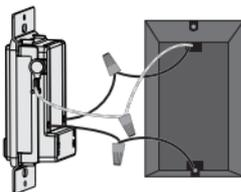
Conecte "LIVE IN" (caja del interruptor) a "~VAC" (control de pared), empleando las tuercas para cable proporcionadas.
