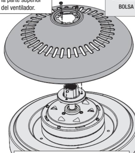
Alinee las muescas en la carcasa superior del motor con las pestañas en el adaptador del motor. Inserte los tornillos del motor superior, que se encuentra en la bolsa de materiales ●, y ajústelos bien.
