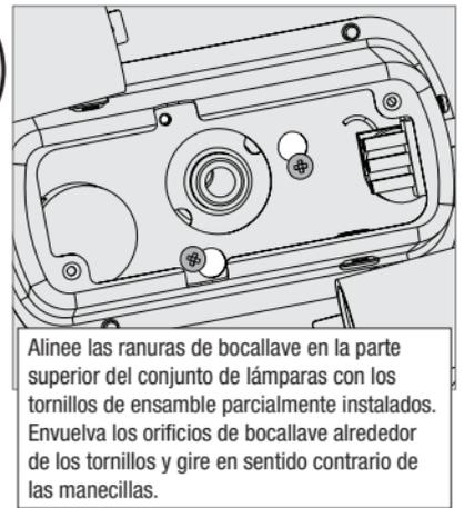
Alinee las ranuras de bocallave en la parte superior del conjunto de lámparas con los tornillos de ensamblaje parcialmente instalados. Envuelva los orificios de bocallave alrededor de los tornillos y gire en sentido contrario de las manecillas.
