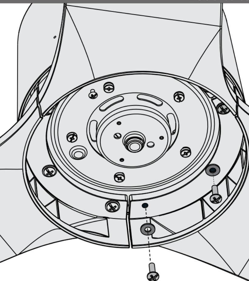
Coloque las arandelas de paleta incluidas en la bolsa de materiales ■ en los tornillos de paleta incluidos en la bolsa de materiales ▲. A continuación instale los tornillos de paleta para fijar ambas paletas al soporte de paleta.
