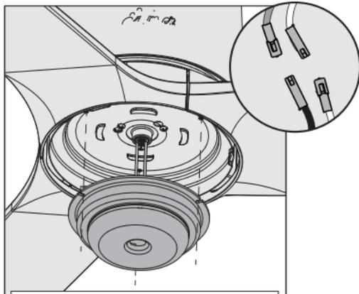
Conecte el cable blanco del ventilador al cable blanco del conjunto de lámparas. Luego, conecte el cable blanco del ventilador al cable negro del conjunto de lámparas.
