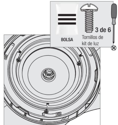
Instale los tres tornillos de caja del interruptor incluidos en la bolsa de materiales
