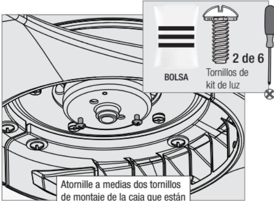
Atornille a medias dos tornillos de montaje de la caja que están en la bolsa de materiales
