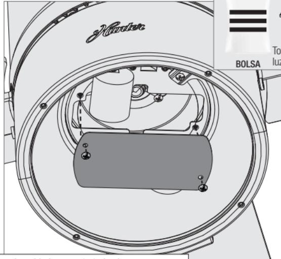
Empuje cuidadosamente todos los componentes de la caja del interruptor en la caja del interruptor, luego instale la placa de la caja del interruptor usando dos tornillos de ensamble del conjunto de lámparas que se encuentran en la bolsa de herrajes.
