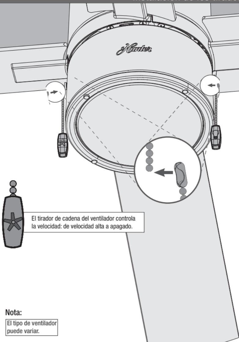
Pase las cadenas para tirar desde el interruptor del ventilador y el interruptor de luz hacia abajo por los orificios en la caja del interruptor superior. Conecte el pendiente de tirador de cadenas a las cadenas para tirar para luz y ventilador.
