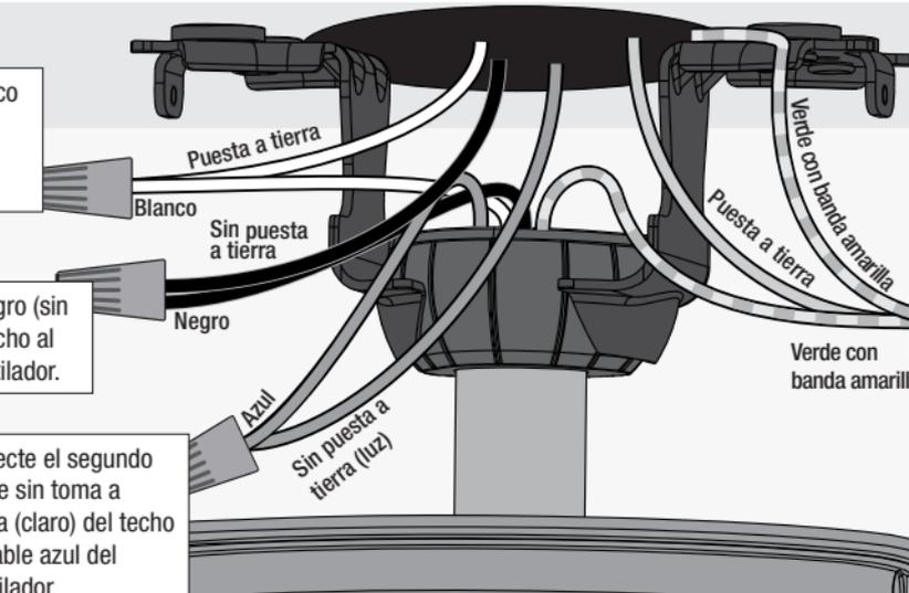
Conecte el cable negro (sin toma a tierra) del techo al cable negro del ventilador.
