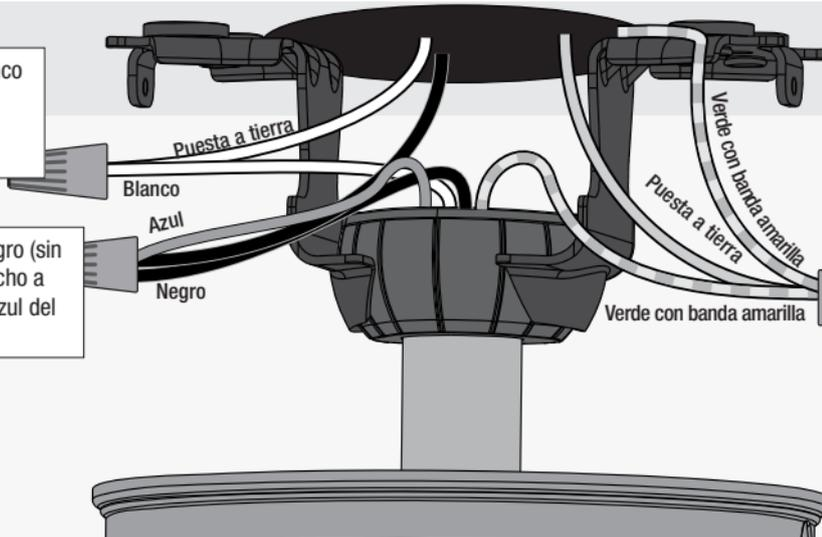
Conecte el cable negro (sin toma a tierra) del techo a los cables negro y azul del ventilador.
