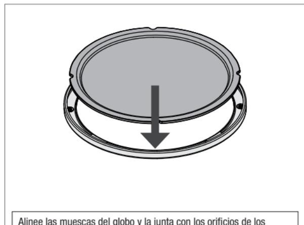
Alinee las muescas del globo y la junta con los orificios de los tornillos del retén del globo y baje con cuidado el globo y la junta en el retenedor del globo hasta que quede en su lugar.
