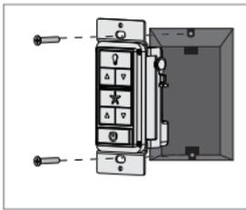
**5** Instalar la placa de cubierta
