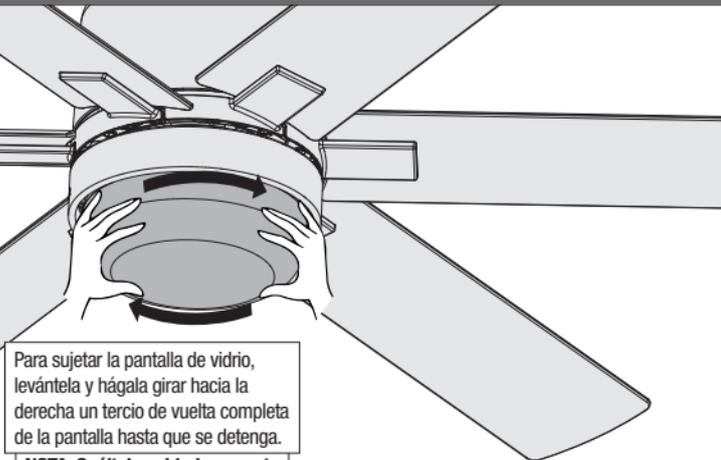
Para sujetar la pantalla de vidrio, levántela y hágala girar hacia la derecha un tercio de vuelta completa de la pantalla hasta que se detenga.
