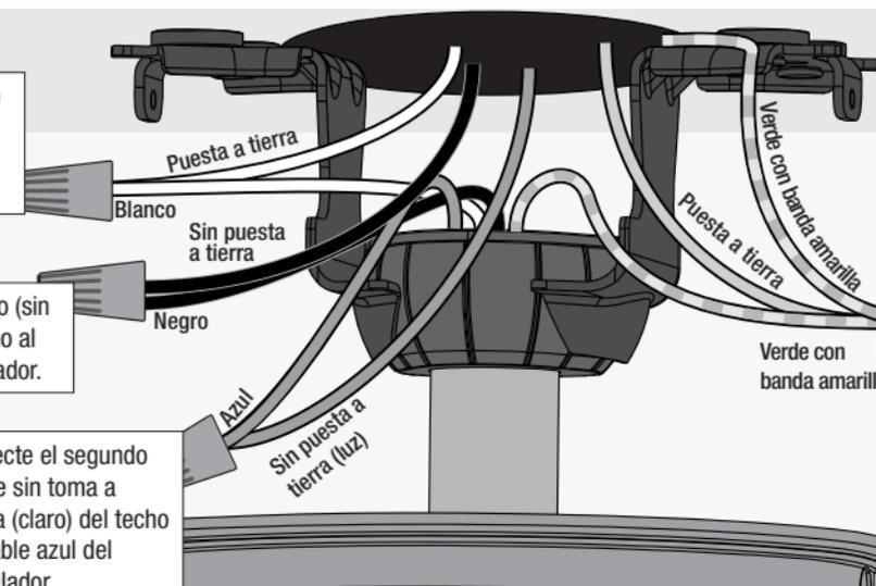
Conecte el cable negro (sin toma a tierra) del techo al cable negro del ventilador.
