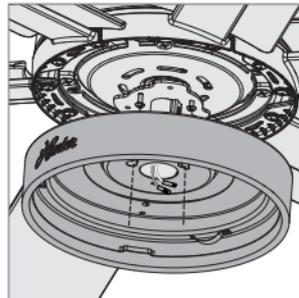
Pase la clavija del alambre a través del agujero central de la caja superior del interruptor, luego envuelva la ranura de bocallave alrededor de los tornillos y gire en sentido antihorario.
