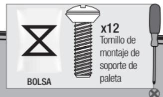
Acopte sin emplear mucha fuerza los soportes de paleta al motor con los tornillos de la bolsa de materiales, luego apriete con firmeza, cuando ambos tornillos estén acoplados.
