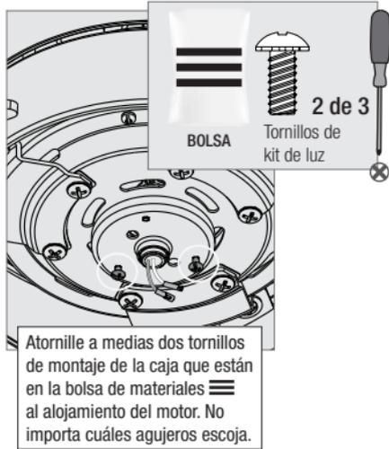
Atornille a medias dos tornillos de montaje de la caja que están en la bolsa de materiales
