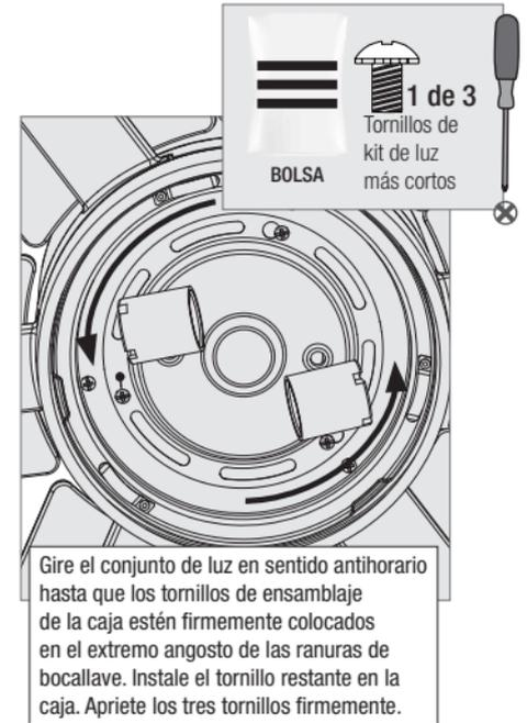
Gire el conjunto de luz en sentido antihorario hasta que los tornillos de ensamblaje de la caja estén firmemente colocados en el extremo angosto de las ranuras de bocallave. Instale el tornillo restante en la caja. Apriete los tres tornillos firmemente.
