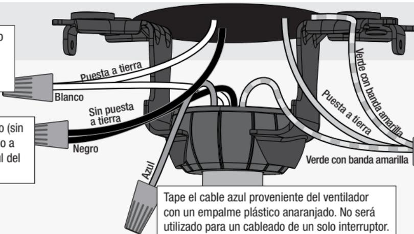
Conecte el cable negro (sin toma a tierra) del techo a los cables negro y azul del ventilador.
