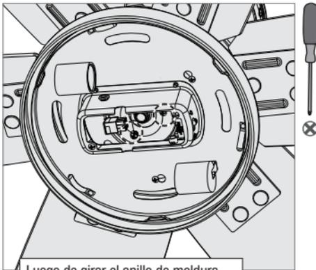
Luego de girar el anillo de moldura en su lugar, ajuste los tres tornillos firmemente.
