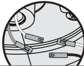
Conecte el cable blanco del ventilador al cable blanco del conjunto de lámparas. Luego, conecte el cable blanco del ventilador al cable negro del conjunto de lámparas.
