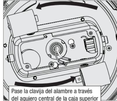
Pase la clavija del alambre a través del agujero central de la caja superior del interruptor, luego envuelva la ranura de bocallave alrededor de los tornillos y gire en sentido antihorario.
