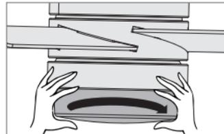
Para sujetar la pantalla de vidrio, levántela y hágala girar hacia la derecha un tercio de vuelta completa de la pantalla hasta que se detenga.
