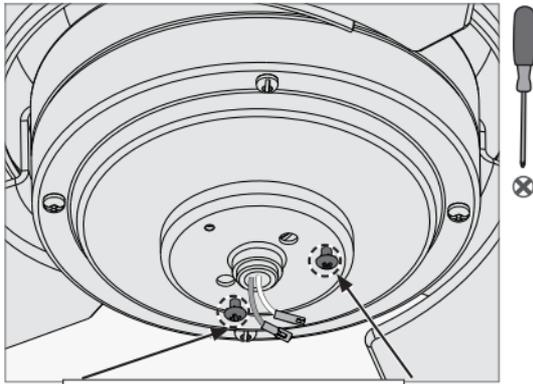
Desajuste los dos tornillos preinstalados.
