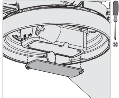
Empuje con cuidado todos los componentes dentro de la caja de interruptores, luego instale la placa de la caja de interruptores usando los dos tornillos preinstalados del conjunto de luz
