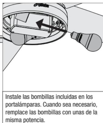
Instale las bombillas incluidas en los portalámparas. Cuando sea necesario, reemplace las bombillas con unas de la misma potencia.
