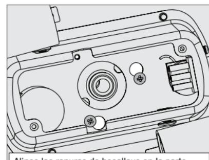
Alinee las ranuras de bocallave en la parte superior del conjunto de lámparas con los tornillos de ensamble parcialmente instalados. Envuelva los orificios de bocallave alrededor de los tornillos y gire en sentido contrario de las manecillas.
