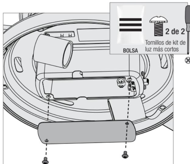
Empuje cuidadosamente todos los componentes de la caja del interruptor en la caja del interruptor, luego instale la placa de la caja del interruptor usando dos tornillos de ensamble del conjunto de lámparas que se encuentran en la bolsa de herrajes.
