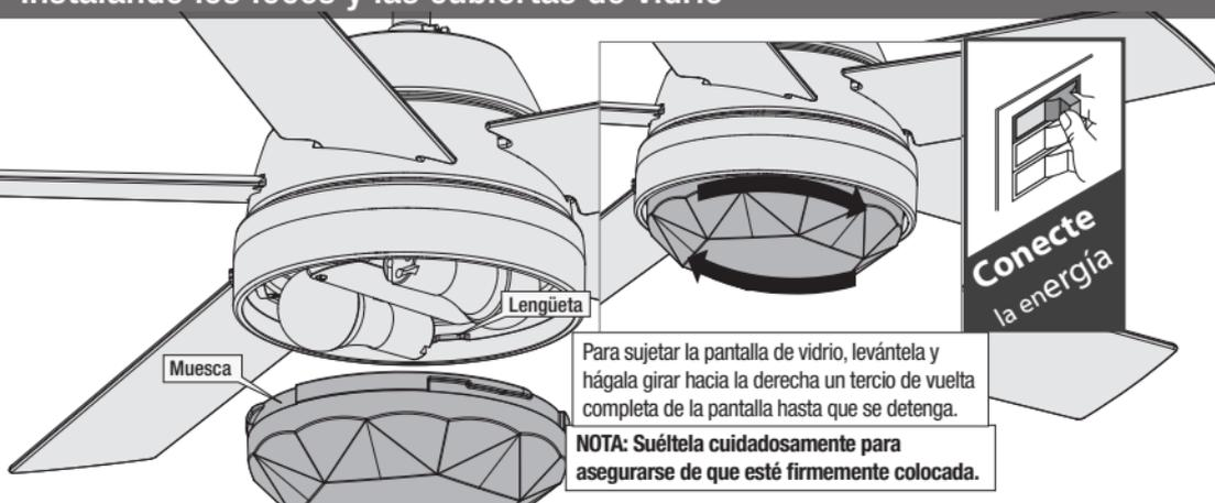
Levante la pantalla y alinee las muescas en la pantalla de vidrio con las lengüetas en el conjunto de luz.
