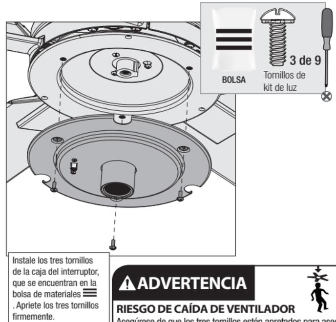
Instale los tres tornillos de la caja del interruptor, que se encuentran en la bolsa de materiales
