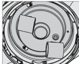
Alinee las ranuras de bocallave en el conjunto de luz con los tornillos de montaje. Asegúrese de que todos los alambres del ventilador y del conjunto de luz estén ajustados dentro del centro del conjunto de luz, y que no estén atascados entre la caja superior del interruptor y el conjunto de luz o colgando de los lados.
