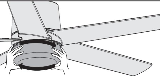
Para sujetar la pantalla de vidrio, levántela y hágala girar hacia la derecha un tercio de vuelta completa de la pantalla hasta que se detenga.
