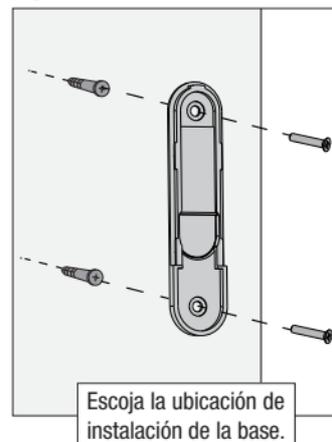
Si está instalando sobre un panel de yeso, perforo dos orificios de 9/64" de ancho usando el soporte de la base como una guía. Martille con cuidado las anclas para panel de yeso incluidas en los orificios previamente perforados.
