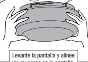
Levante la pantalla y alinee las muescas en la pantalla de vidrio con las lengüetas en el conjunto de luz.
