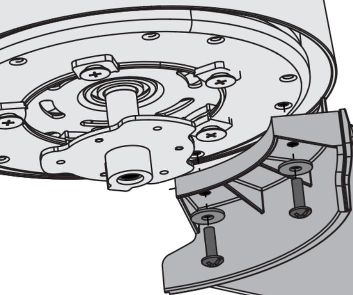
Coloque las arandelas de paleta incluidas en la bolsa de materiales ■ en los tornillos de paleta incluidos en la bolsa de materiales ▲. A continuación instale los tornillos de paleta para fijar ambas paletas al soporte de paleta.
