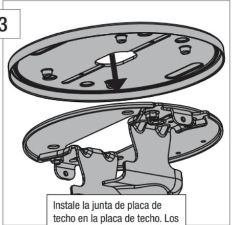
Instale la junta de placa de techo en la placa de techo. Los cuatro orificios en la placa de techo deberían alinearse con los cuatro postes en la junta.
