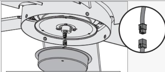
Levante la caja inferior del interruptor y conecte los enchufes. Asegúrese de alinear las marcas de color ubicadas en los conectores y que los conectores enganchen.
