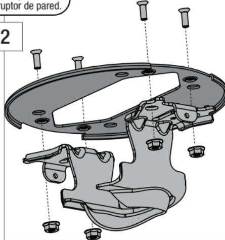
Alinee los orificios cónicos de montaje situados en la placa de techo con los orificios del soporte de techo. Instale los cuatro tornillos de placa de techo incluidos en la bolsa de materiales y fíjelos con las tuercas de brida mediante una llave de 11/32". Sostenga el conjunto de soporte de techo hacia arriba contra la caja de salida y marque la posición de los tornillos. Para el montaje en una estructura de soporte, marque también el techo para taladrar orificios pilotos.
