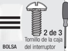
Alinee los orificios de tornillo de la empaquetadura de la caja del interruptor. Atornille a medias dos tornillos de montaje de la caja que están en la bolsa de materiales ■ al alojamiento del motor. No importa cuáles agujeros escoja.
