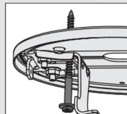
Atraviese la junta de caucho con el tornillo para madera con el objeto de instalar el conjunto de soporte de techo en la estructura de soporte o en la caja de salida aprobada para ventiladores de techo.
