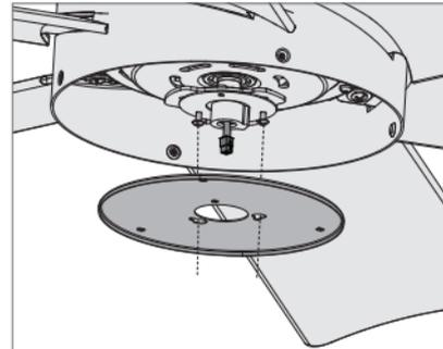
Pase la clavija del alambre a través del agujero central de la caja superior del interruptor, luego envuelva la ranura de bocallave alrededor de los tornillos y gire en sentido antihorario.
