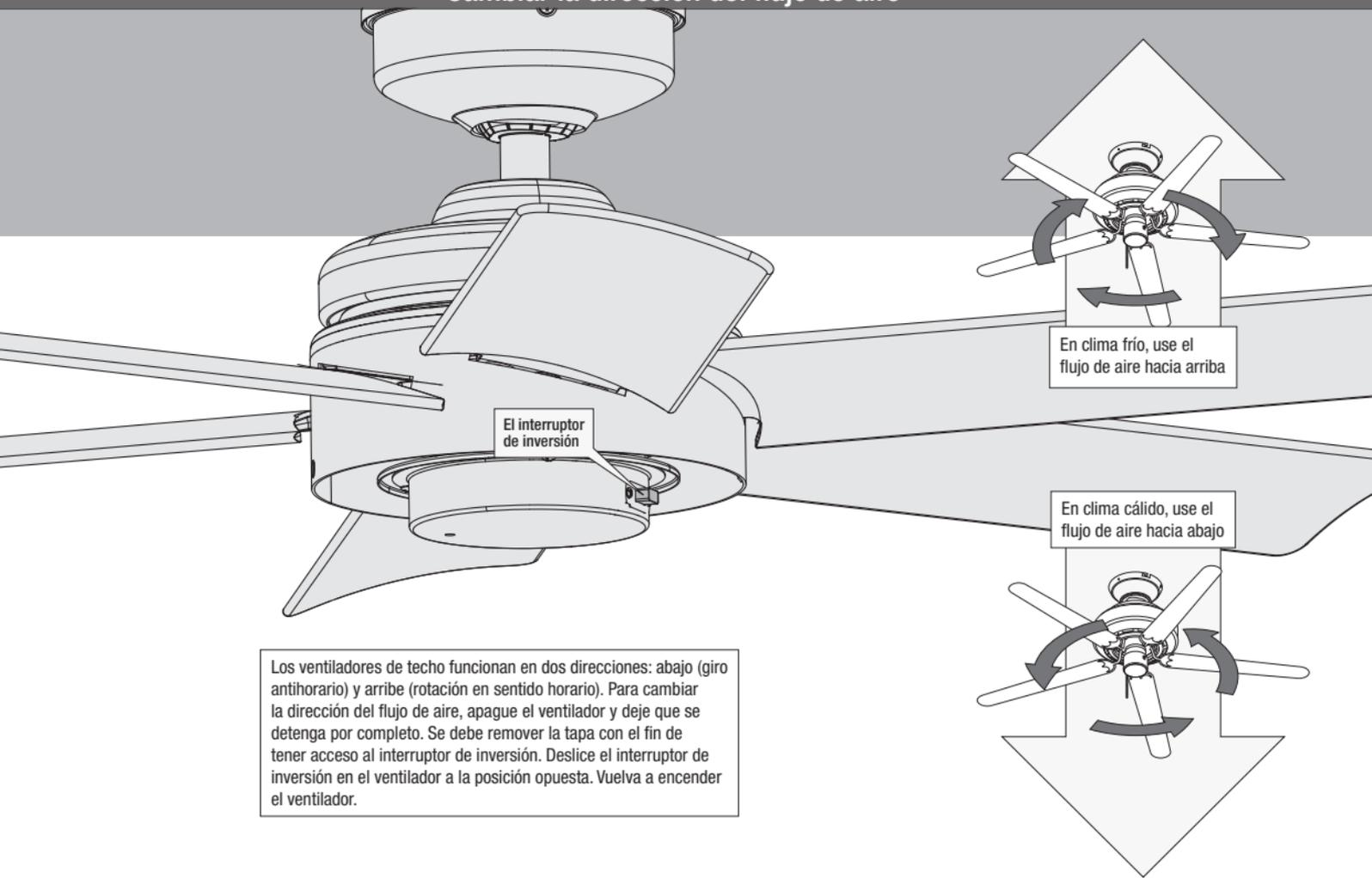
Los ventiladores de techo funcionan en dos direcciones: abajo (giro antihorario) y arriba (rotación en sentido horario). Para cambiar la dirección del flujo de aire, apague el ventilador y deje que se detenga por completo. Se debe remover la tapa con el fin de tener acceso al interruptor de inversión. Deslice el interruptor de inversión en el ventilador a la posición opuesta. Vuelva a encender el ventilador.
