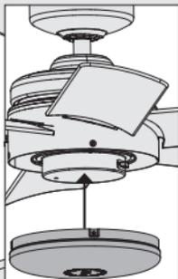
Levante la tapa y alinee los orificios de la tapa con las pestañas de extensión de la carcasa del ventilador.
