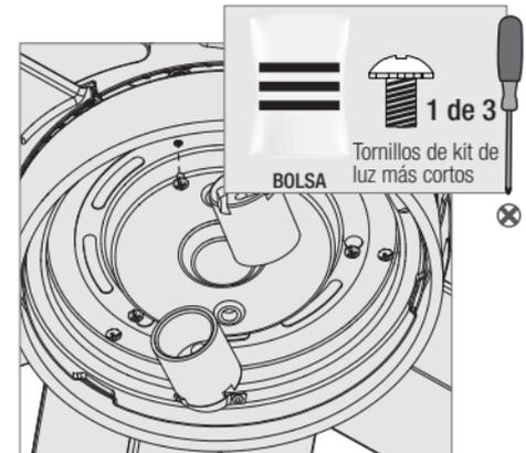
Gire el conjunto de luz en sentido antihorario hasta que los tornillos de ensamble de la caja estén firmemente colocados en el extremo angosto de las ranuras de bocallave. Instale el tornillo restante en la caja. Apriete los tres tornillos firmemente.
