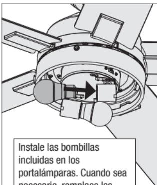
Instale las bombillas incluidas en los portalámparas. Cuando sea necesario, reemplace las bombillas con unas de la misma potencia.
