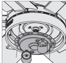
Alinee las ranuras de bocallave en el conjunto de luz con los tornillos de montaje. Asegúrese de que todos los alambres del ventilador y del conjunto de luz estén ajustados dentro del centro del conjunto de luz, y que no estén atascados entre la caja superior del interruptor y el conjunto de luz o colgando de los lados.
