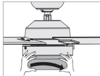
Para sujetar la pantalla de vidrio, levántela y hágala girar hacia la derecha un tercio de vuelta completa de la pantalla hasta que se detenga.
