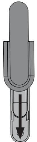
Deslice la base sobre el soporte ya montado.
