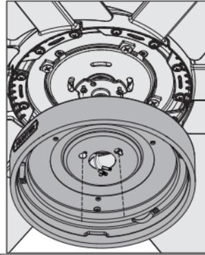
Pase la clavija del alambre a través del agujero central de la caja superior del interruptor, luego envuelva la ranura de bocallave alrededor de los tornillos y gire en sentido antihorario.
