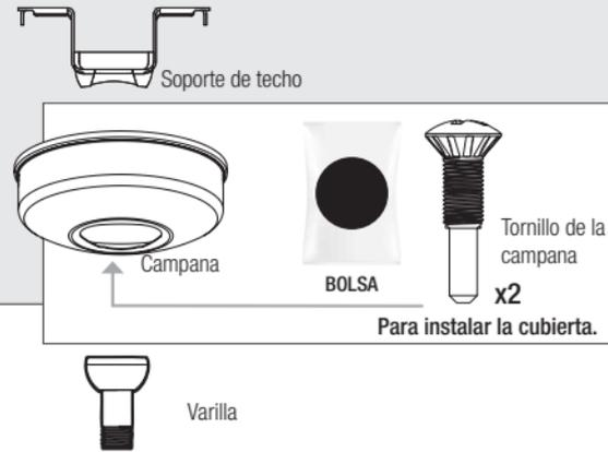
Para instalar la cubierta.
