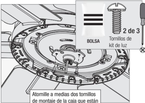
Atornille a medias dos tornillos de montaje de la caja que están en la bolsa de materiales
