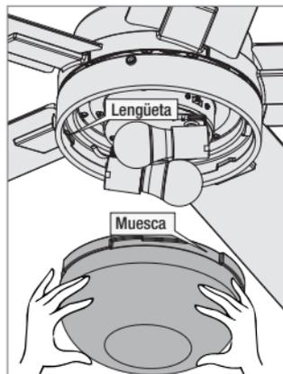
Levante la pantalla y alinee las muescas en la pantalla de vidrio con las lengüetas en el conjunto de luz.
