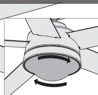
Para sujetar la pantalla de vidrio, levántela y hágala girar hacia la derecha un tercio de vuelta completa de la pantalla hasta que se detenga.
