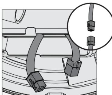
Pase el conector de 9 pines que viene de la parte inferior del alojamiento del motor a través de orificio central en el conjunto de lámparas. Conéctelo en el conector de enchufe que se encuentra en el área de la caja del interruptor del conjunto de lámparas. Asegúrese de alinear las marcas de color de los conectores.
