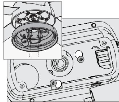
Alinee las ranuras de bocallave en la parte superior del conjunto de lámparas con los tornillos de ensamble parcialmente instalados. Envuelva los orificios de bocallave alrededor de los tornillos y gire en sentido contrario de las manecillas.
