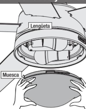
Levante la pantalla y alinee las muescas en la pantalla de vidrio con las lengüetas en el conjunto de luz.
