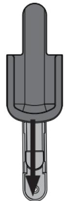
Deslice la base sobre el soporte ya montado.
