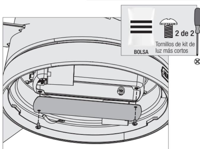
Empuje cuidadosamente todos los componentes de la caja del interruptor en la caja del interruptor, luego instale la placa de la caja del interruptor usando dos tornillos de ensamble del conjunto de lámparas que se encuentran en la bolsa de herrajes.
