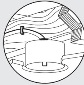
Debe tener la capacidad de asegurar el ventilador a la estructura de la edificación o caja de salida aprobada para ventiladores
