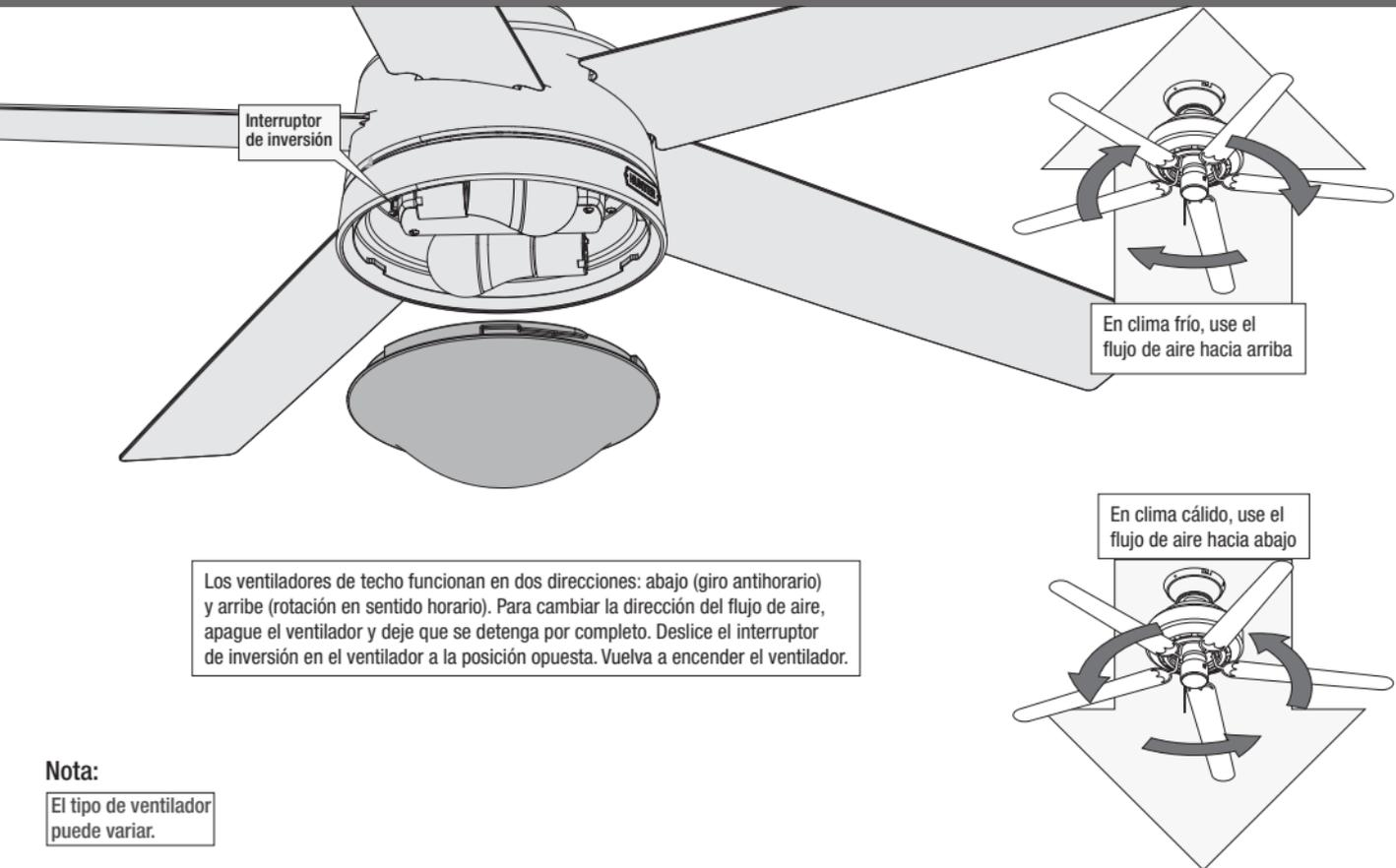
Los ventiladores de techo funcionan en dos direcciones: abajo (giro antihorario) y arriba (rotación en sentido horario). Para cambiar la dirección del flujo de aire, apague el ventilador y deje que se detenga por completo. Deslice el interruptor de inversión en el ventilador a la posición opuesta. Vuelva a encender el ventilador.
