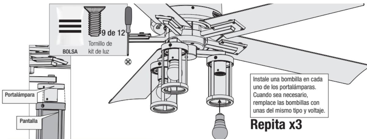
Levante el conjunto de vidrio hasta que sus orificios para tornillo estén alineados con los orificios para tornillo de uno de los portafocos del conjunto de lámpara. Asegure con los tres tornillos del conjunto de lámpara que se encuentran en la bolsa de tornillería .
