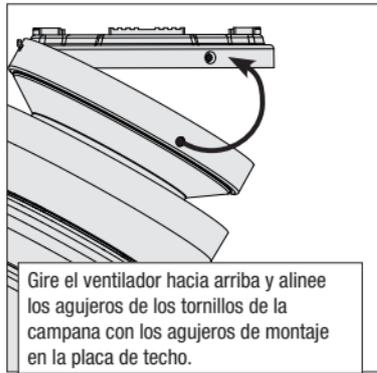
Gire el ventilador hacia arriba y alinee los agujeros de los tornillos de la campana con los agujeros de montaje en la placa de techo.
