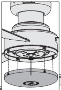
Levante la tapa y alinee los orificios de la tapa con las pestañas de extensión de la carcasa del ventilador.
