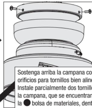
Sostenga arriba la campana con los orificios para tornillos bien alineados. Instale parcialmente dos tornillos de la campana, que se encuentran en la ● bolsa de materiales, dentro de los orificios opuestos a los ganchos del soporte de suspensión.
