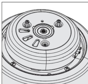
Afloje los dos tornillos preinstalados de la campana de tal manera que sigan enganchados.
