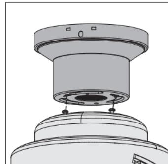
Pase los alambres del ventilador a través del orificio central de la campana, luego coloque las ranuras tipo bocallave alrededor de los tornillos de la campana y gire en sentido contrario a las agujas del reloj.
