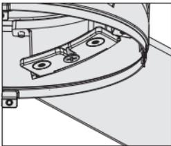
Inserte la hoja en la ranura de la hoja alrededor del tornillo central. Coloque las arandelas de paleta incluidas en la bolsa de materiales ■ en los tornillos de paleta incluidos en la bolsa de materiales ▲. A continuación instale los tornillos de paleta para fijar ambas paletas al soporte de paleta.
