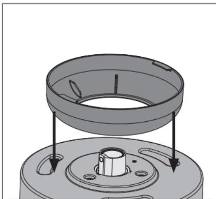
Coloque el anillo de moldura en la tapa superior.
